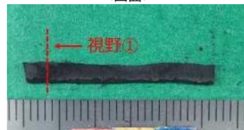
A蒸気発生器 第一管支持板上部（高温側）から回収した長尺型スケール
