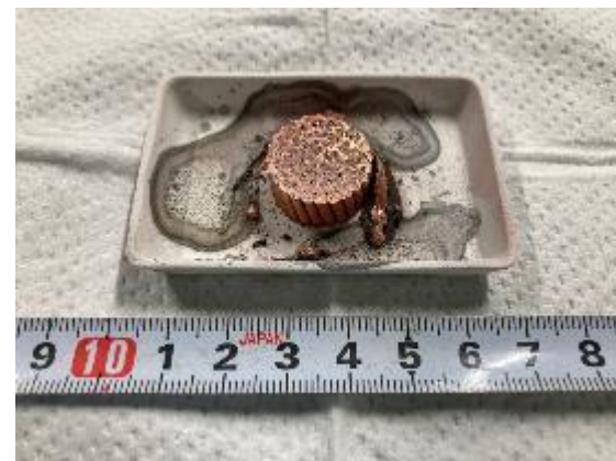
試験後 (1000°C水蒸気環境下)
