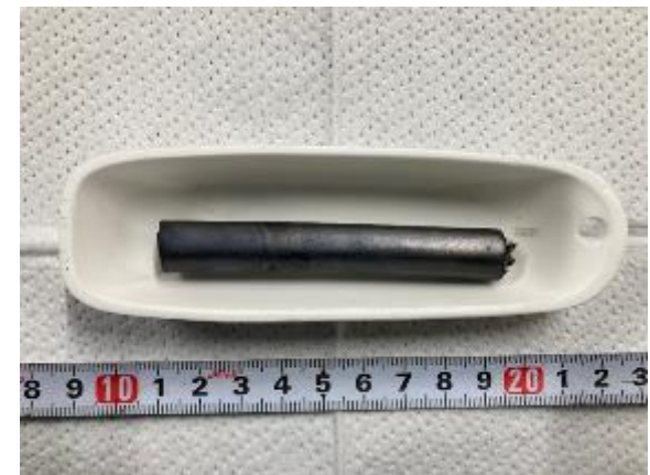
試験後 (200°C水蒸気環境下)
