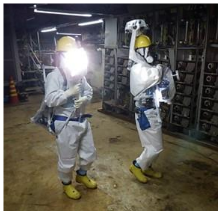
ウェアラブル型3Dスキャン装置 (4号機R/Bにおけるモックアップの様子)
