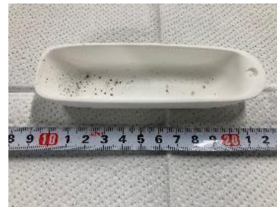
試験後 (1000°C水蒸気環境下)
