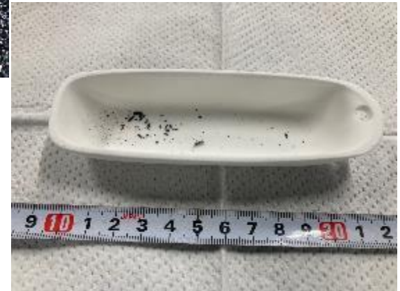
試験後 (1000°C水蒸気環境下)
