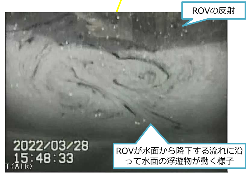
写真3.地震後に確認された水面の汚れ
