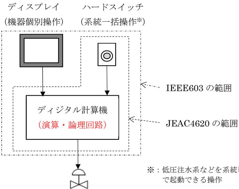
(3) 11 ページ (3) において、規格本文において安全保護系の定義として検出器を含むとされているが、本規格のデジタル安全保護系の範囲は、検出器とみなす核計装や安全系の放射線モニタを含まない「原子炉停止系及び工学的安全施設作動系の演算・論理回路を有するデジタル計算機」のみを対象とした狭義の範囲を対象としているとの説明がありました。
