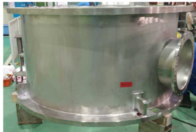
製作中のSTACY炉心タンク(左:上半分、右:下半分)*
