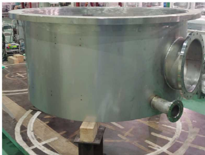
製作中のSTACY炉心タンク(左:上半分、右:下半分)*
