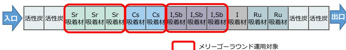
図 II-2 吸着塔構成の例 (2018 年 9 月時点での例)
