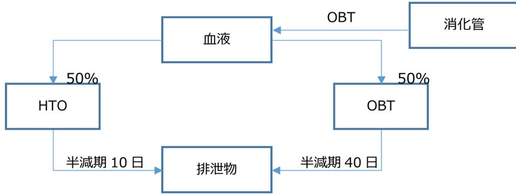
**図 III-2 OBT 摂取の ICRP モデル**
