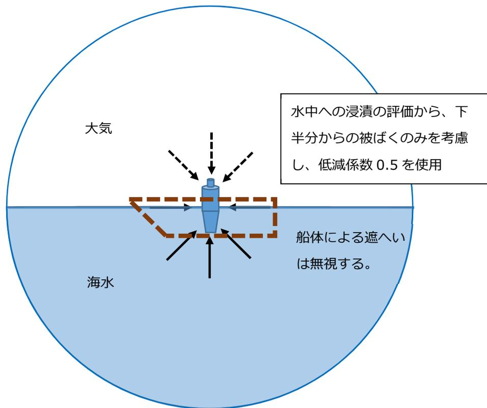
図 XI-1 海上作業における海水中の放射性物質からの被ばく評価モデルの概念図
