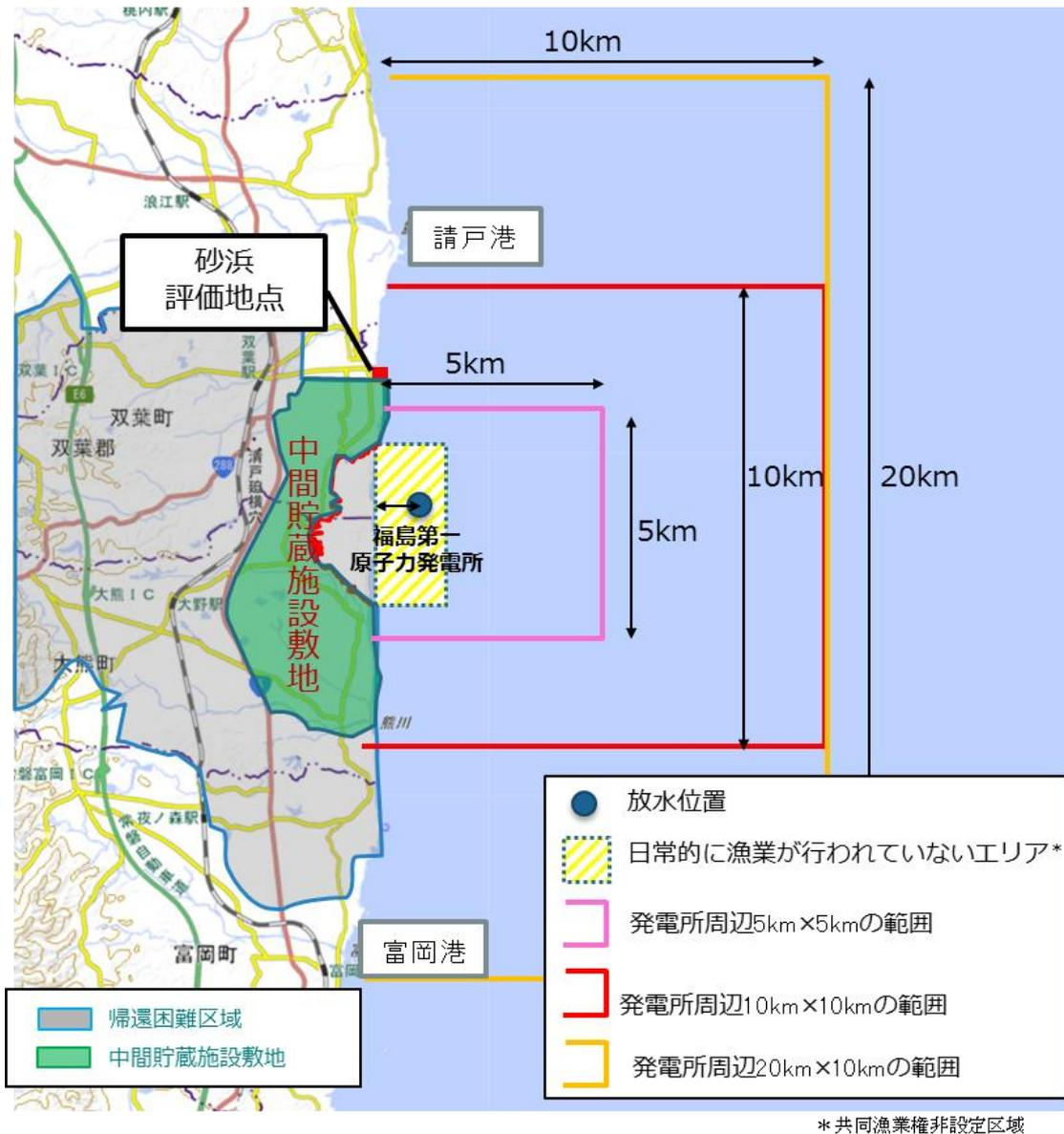
図 6-1-11 通常時の被ばく評価に使用する海水濃度の評価地点
