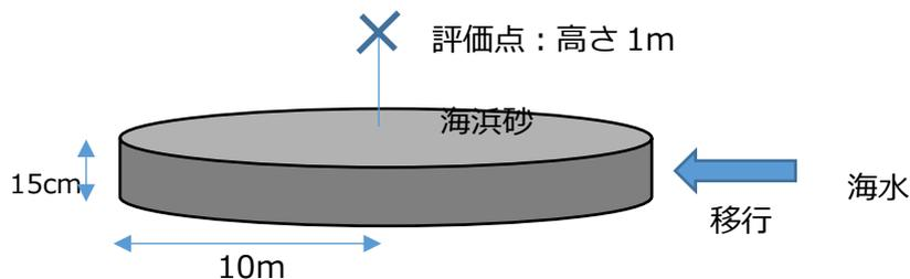
図 6-1-8 廃止措置ハンドブックにおける海浜砂からの被ばく評価モデル
