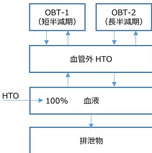
**図 III-3 HTO 摂取の ICRP 新モデル**
