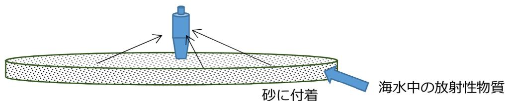
図 XI-4 海浜砂に付着した放射性物質からの被ばく評価モデルの概念図
