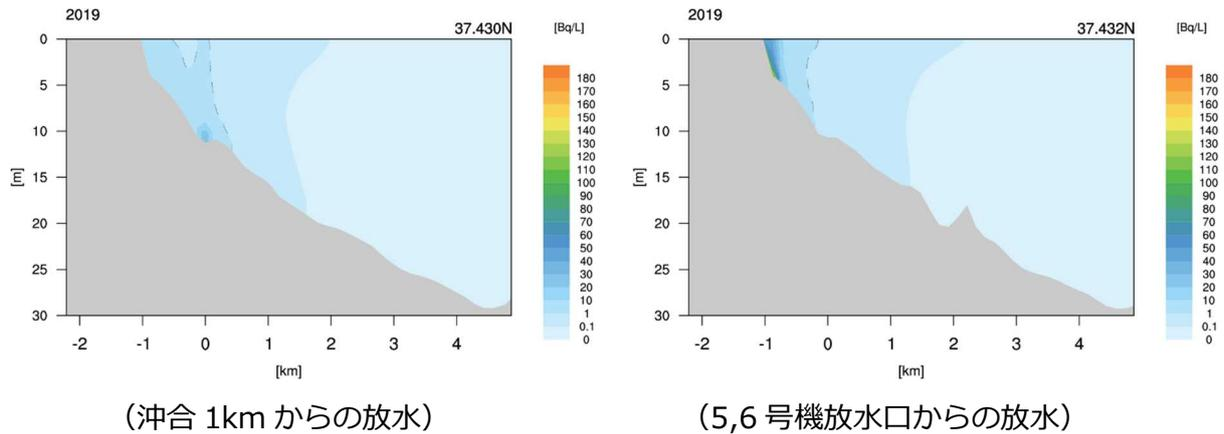
図 VII-6 放水位置の違いによる海水のトリチウム年間平均濃度分布図の比較（断面図）
