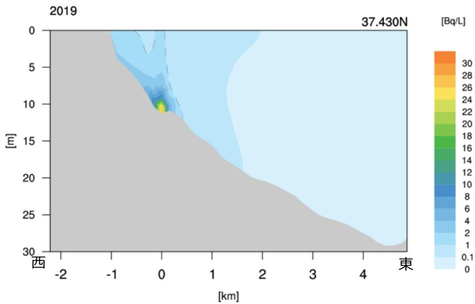
図 6-1-15 海中の年間平均濃度分布図（放水位置東西断面）
