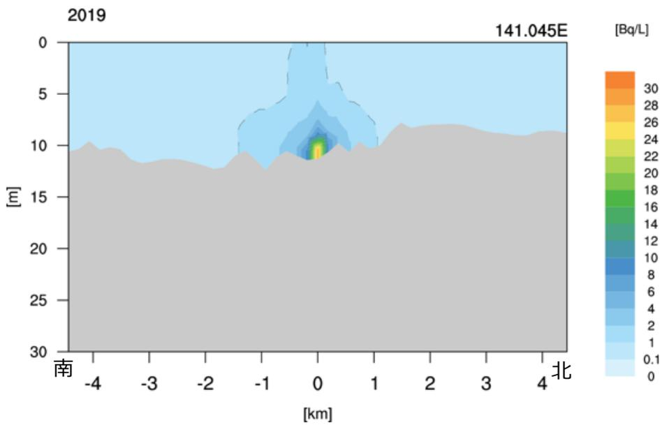
図 6-1-16 海中の年間平均濃度分布図（放水位置南北断面）
