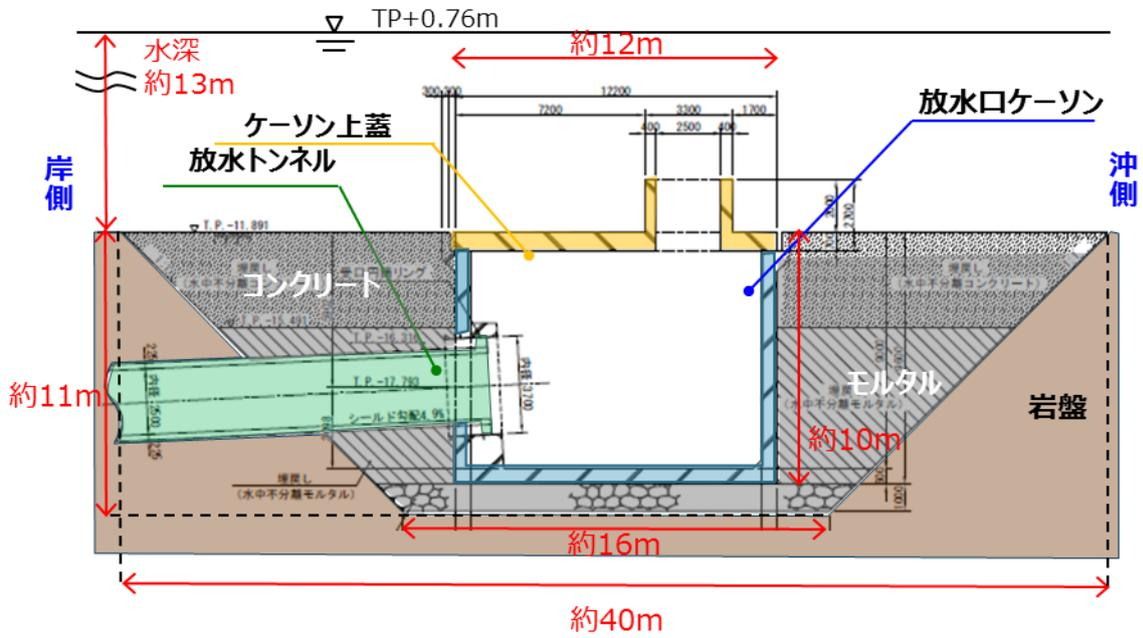
図 5-3-11 放水口断面図
