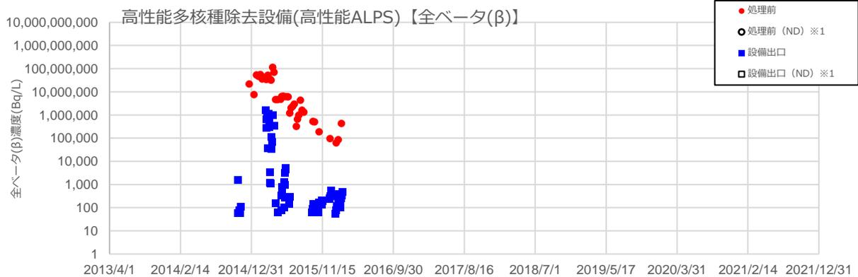
図 II-5-8 各多核種除去設備出入口における放射能濃度（全ベータ核種）
