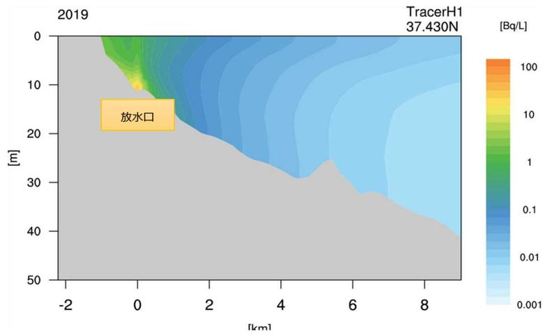
図 VII-8 沖合 10km 付近までのトリチウム年平均濃度分布断面図
