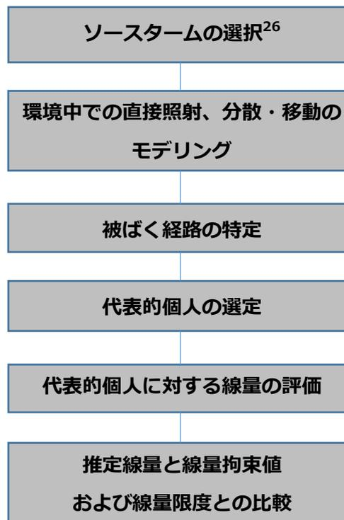
図 6-1-1 被ばく評価の手順（GSG-10 より作成）
