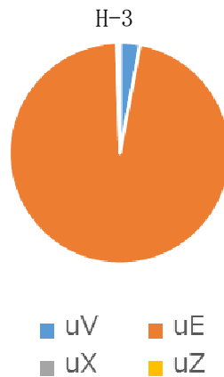
図 3.4-27 低バック液体シンチレーション計数装置によるトリチウム放射能濃度の不確かさ要因と評価結果
