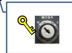
・移送許可についてはキースイッチ操作（ハード）及び移送行程実行PB（ソフト）の『ダブルアクション』により移送工程実行とする。
