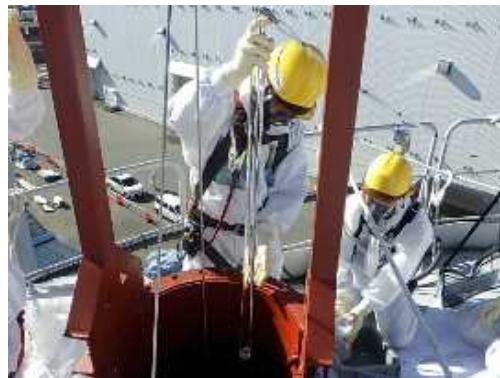
攪拌実証試験当日の採水の様子 (タンク上部にて撮影)
