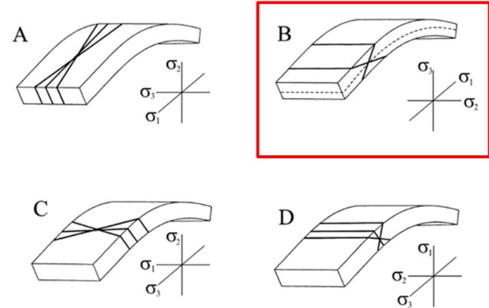
A(横ずれ), B(逆断層)は $\sigma_1$ が層理面に平行で褶曲軸に直交, C(横ずれ)は $\sigma_1$ が層理面・褶曲軸に平行, D(正断層)は $\sigma_1$ が層理面・褶曲軸に直交。
