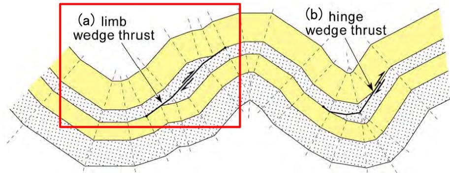
このような低角逆断層は、変位量が比較的小さく急激に減少し、上盤が背斜軸に向かって上がる形態を示す。
