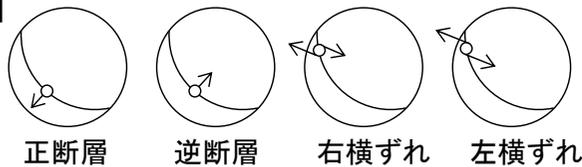
正断層 逆断層 右横ずれ 左横ずれ
