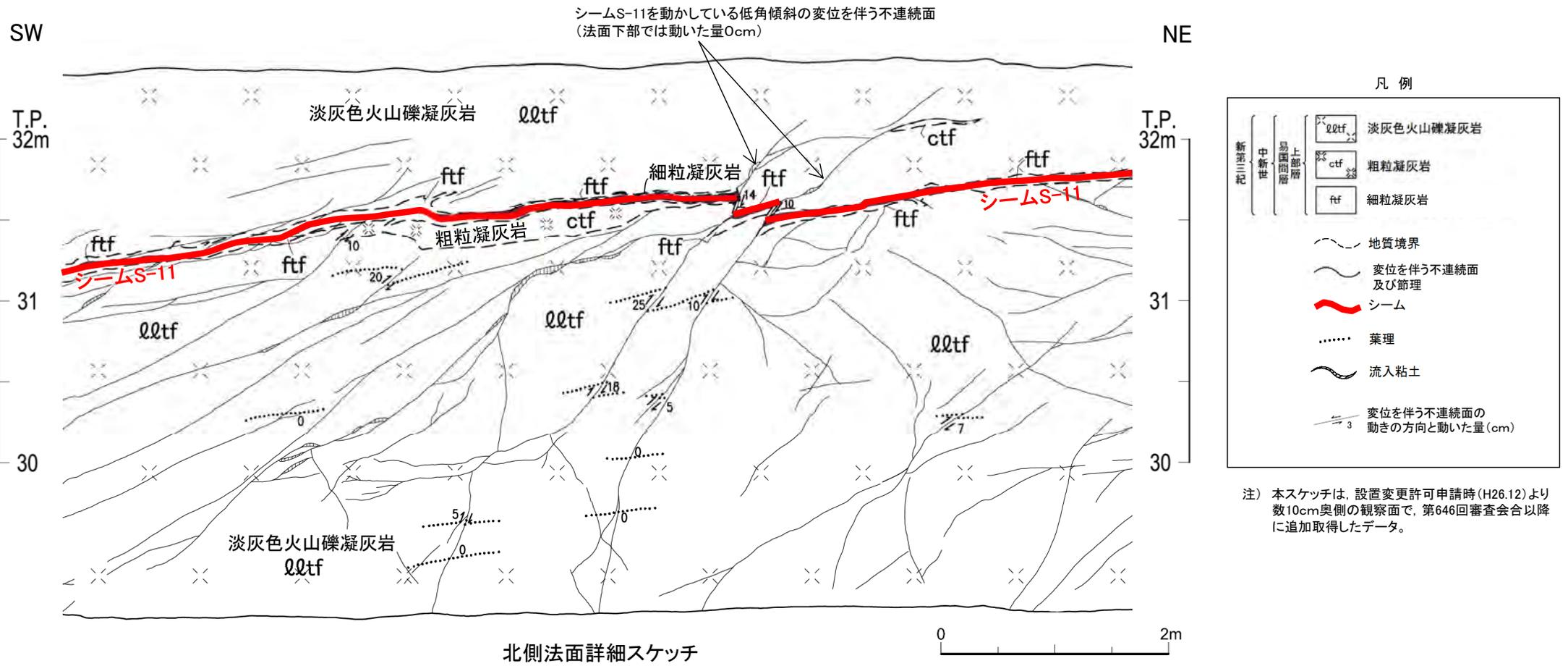
北側法面の現地調査時(H30.11)の法面観察の結果、シームS-11を動かしている低角傾斜の変位を伴う不連続面は、下位に向かって動いた量は小さくなり、法面下部で動いた量は0cmとなることから、設置変更許可申請時(H26.12)の変位を伴う不連続面沿いの動いた量の分布(P.8-14参照)と調和的であることを確認した。
