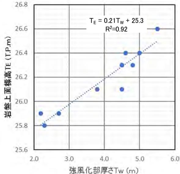
Ts-6法面における強風化部の厚さ( $T_w$ )と岩盤上面の標高( $T_E$ )
