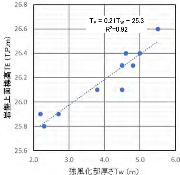
Ts-6法面における強風化部の厚さ(T<sub>W</sub>)と岩盤上面の標高(T<sub>E</sub>)
