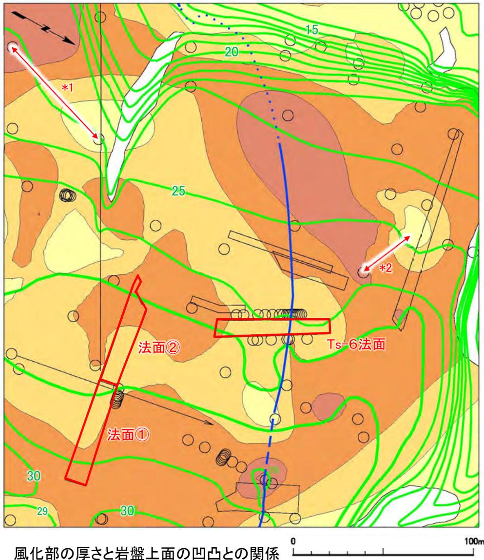
風化部の厚さと岩盤上面の凹凸との関係
