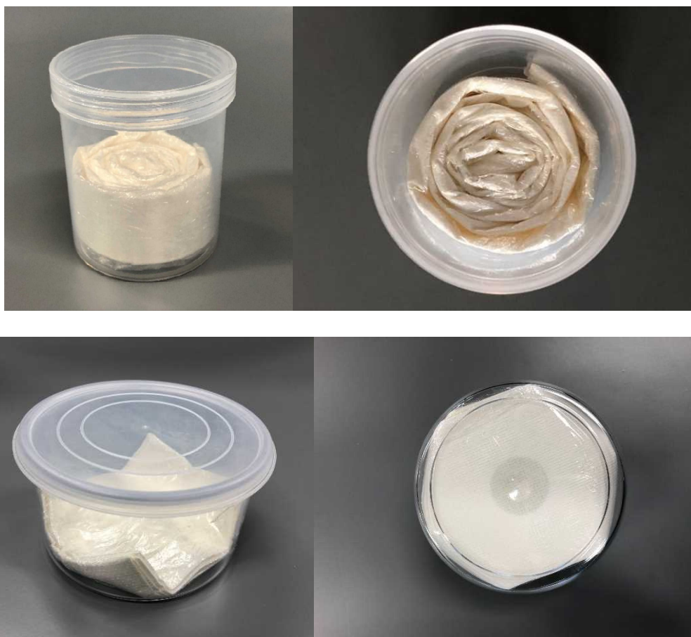
図 4-4 長尺ろ紙 (78 mm×700 mm) を充填した例 (上：集じん面が底に近づくよう細長く折ってロール状に U-8 容器に充填した例、 下：集じん面が中心になるよう 1 時間分ごとに重ねて折って V-9 容器に充填した例)
