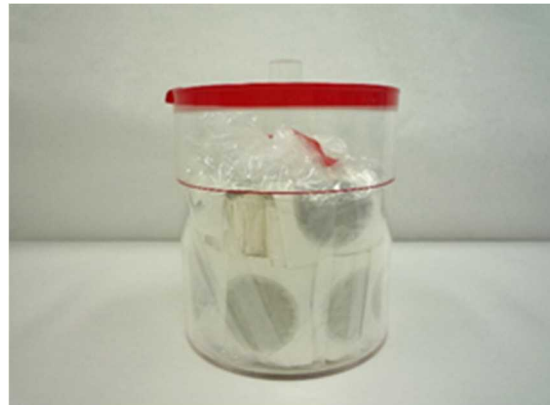
写真 6.7 ビニールテープによる蓋の固定 (長尺ろ紙)
