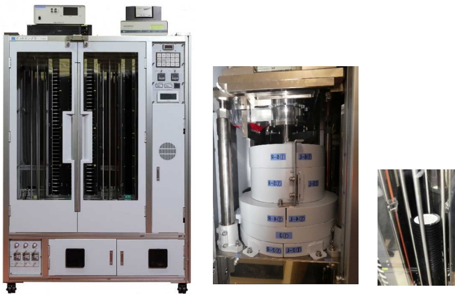
図参 C-6 ゲルマニウム半導体検出器を用いたダストモニタの例
