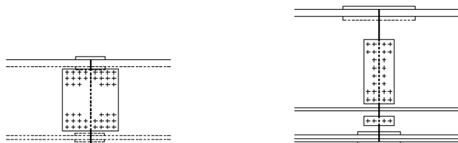
(a) 上フランジ ボルト種類：SHTB M24 ボルト本数：22 本
