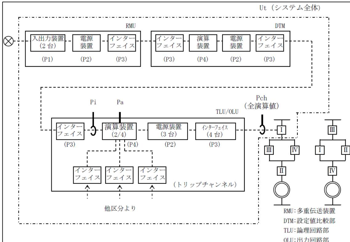
評価対象は、装置の入力からロードドライバ開までのデジタル安全保護系（一点鎖線の範囲）を対象としています。システム全体のアンアベイラビリティを構成要素のアベイラビリティを組み合わせることにより求めます。ここでは、原子炉スクラン要求時にスクランが失敗する確率として、*2 out of 4* システムの 3 重故障を求めます。また、誤動作率については、最初の故障の修理中に 2 番目の故障が生じる 2 重故障で誤スクランが生じる頻度を求めます。
