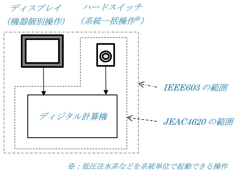
日本電気協会は、海外規格基準との比較について、IEEE7-4.3.2 (IEEE603 含む) との比較を表(2)-1、表(2)-2 に示したとしているが、これらの表は項目単位の対比表であり、その内容の比較としては必ずしも十分ではない。特に、規格基準類の適用範囲について IEEE では操作スイッチ、検出器等を含む広い範囲の安全系設備を対象としているのに対し、デジタル安全保護系規程 2020 の適用範囲はこれに比べて限定的である。
