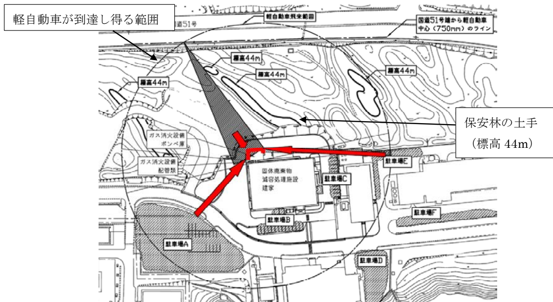
図-23 屋外のガス消火設備の配管類に到達し得る飛来範囲 ②【軽自動車】
