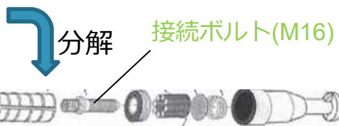
セグメントとスクリューボルト継手(接続部)
