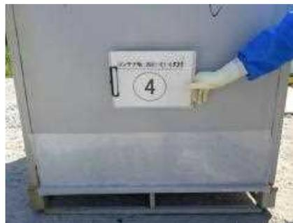
コンテナの外観目視点検により、著しい腐食、へこみが確認されたものについては補修を実施
