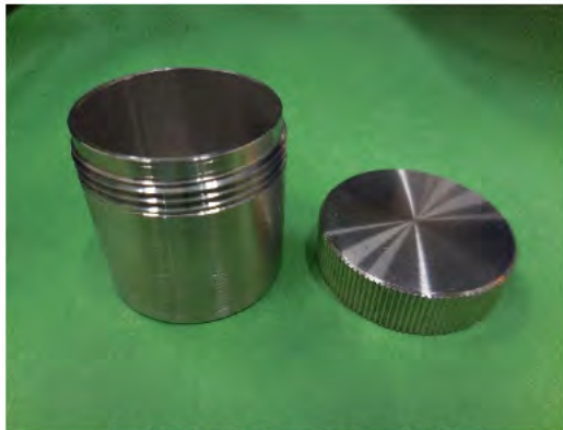
貯蔵施設に保管する密閉容器 (試料を密閉容器 (金属製) に入れ保管)
