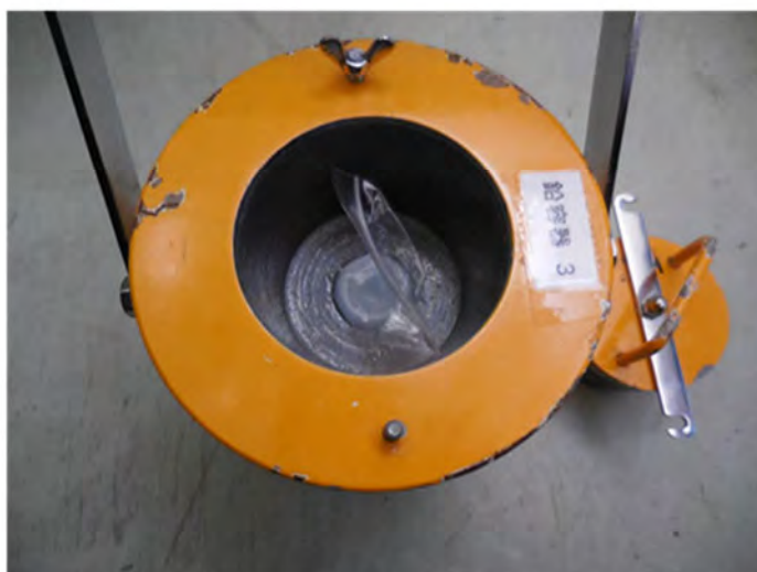
図 9-5 遮蔽容器(鉛製)の例
