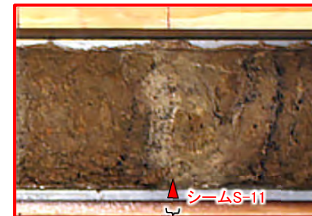
3.80m~3.81m: 細粒凝灰岩が分布する。
