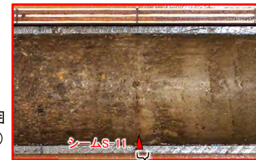
6.40m~6.41m: 細粒凝灰岩が分布する。
