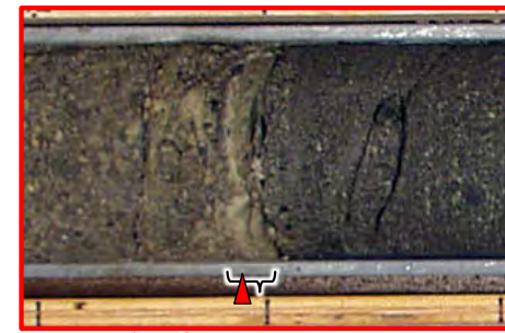
シームS-11 9.18m~9.19m: 細粒凝灰岩が分布する。
