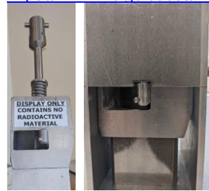
図 ラッチスプリングとノッチにラッチが固定されている状態 https://www.nrc.gov/docs/ML2127/ML21274A019.pdf
