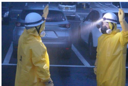
汚染・被水防護服着用時の視認性, 可聴性, コミュニケーション検証 (夜間)
