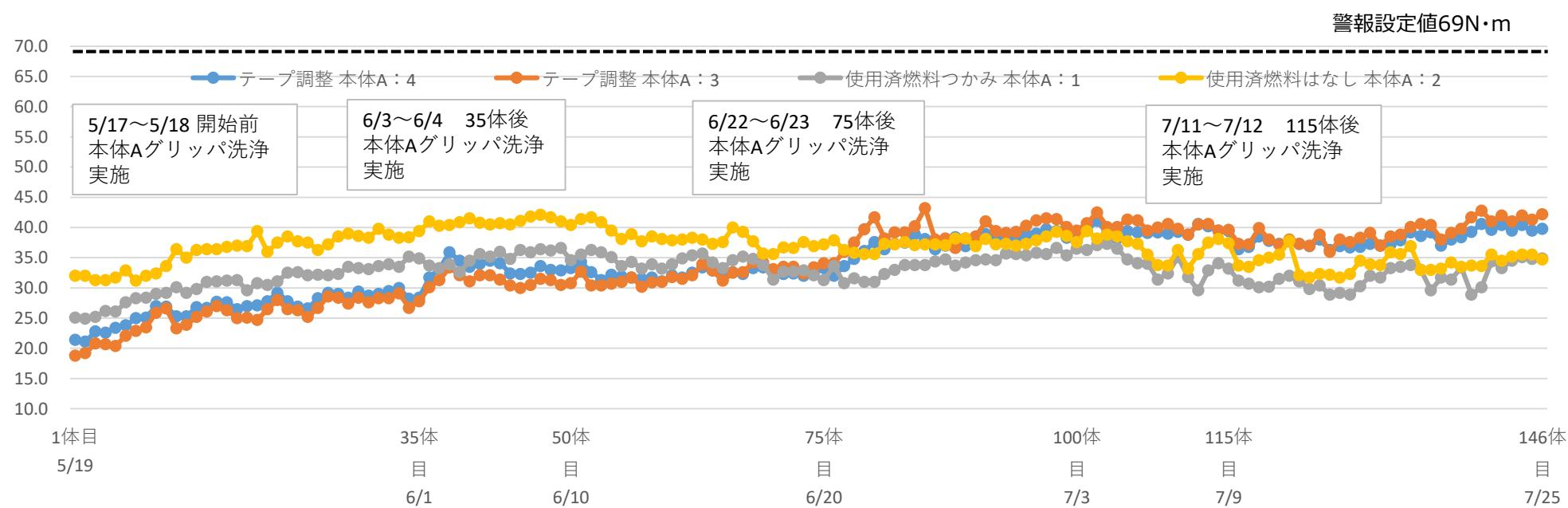
燃料出入機本体Aの爪開閉トルクの推移（単位：N・m）
