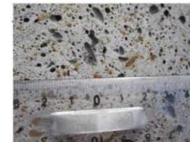
図1 模擬燃料デブリ (ドイツでの試験)
