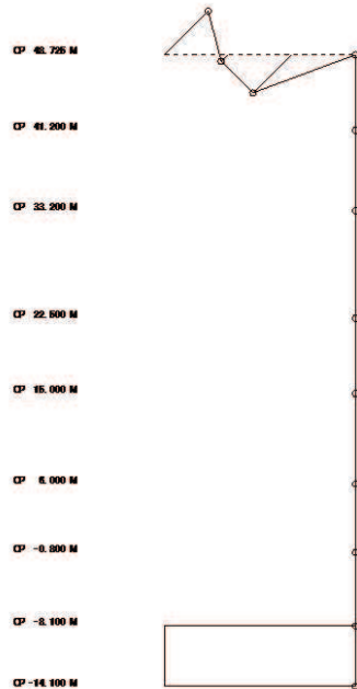
図 2-30 原子炉建屋 固有振動モード (鉛直方向)
