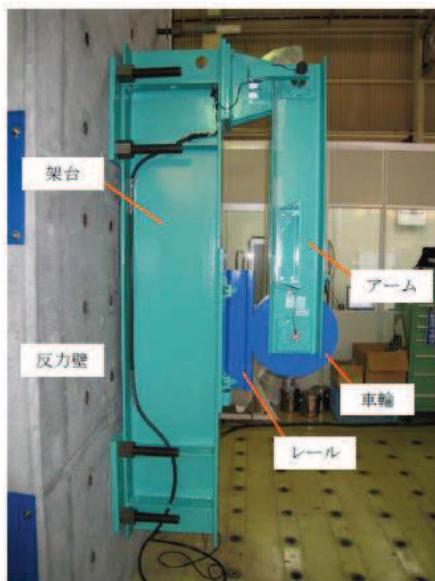
図 1-7 車輪反発係数試験体*
