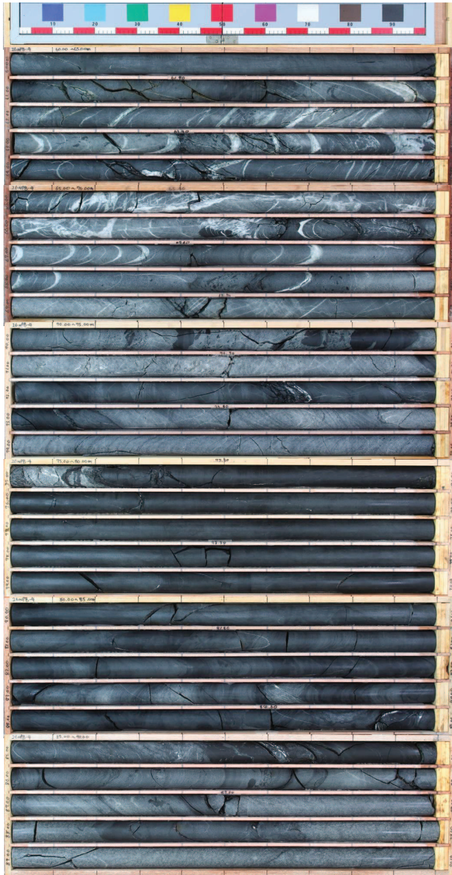
図 2-18(6) ボーリングコア写真 (26NPB-4) (深度 60~90m)
