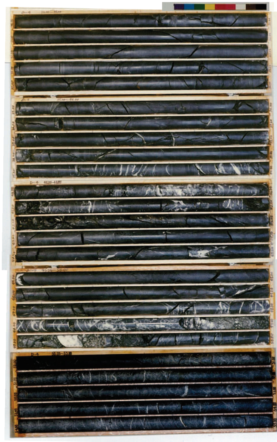
図 2-17(4) ボーリングコア写真 (D-4) (深度 30~55m)
