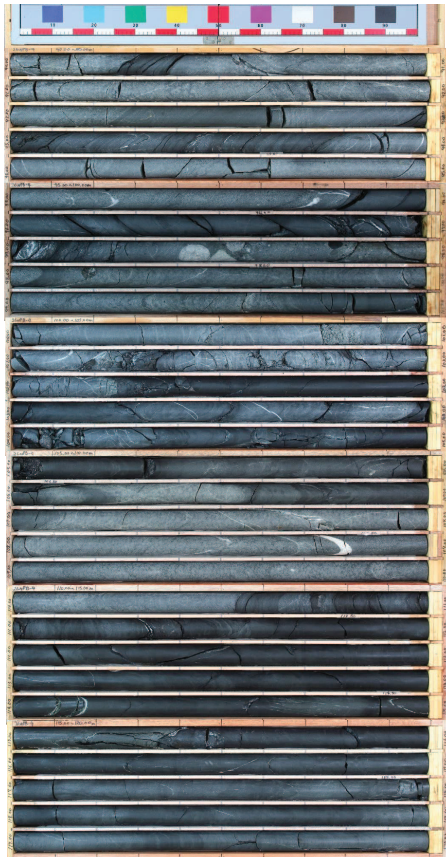
図 2-18(8) ボーリングコア写真 (26NPB-4) (深度 90~120m)
