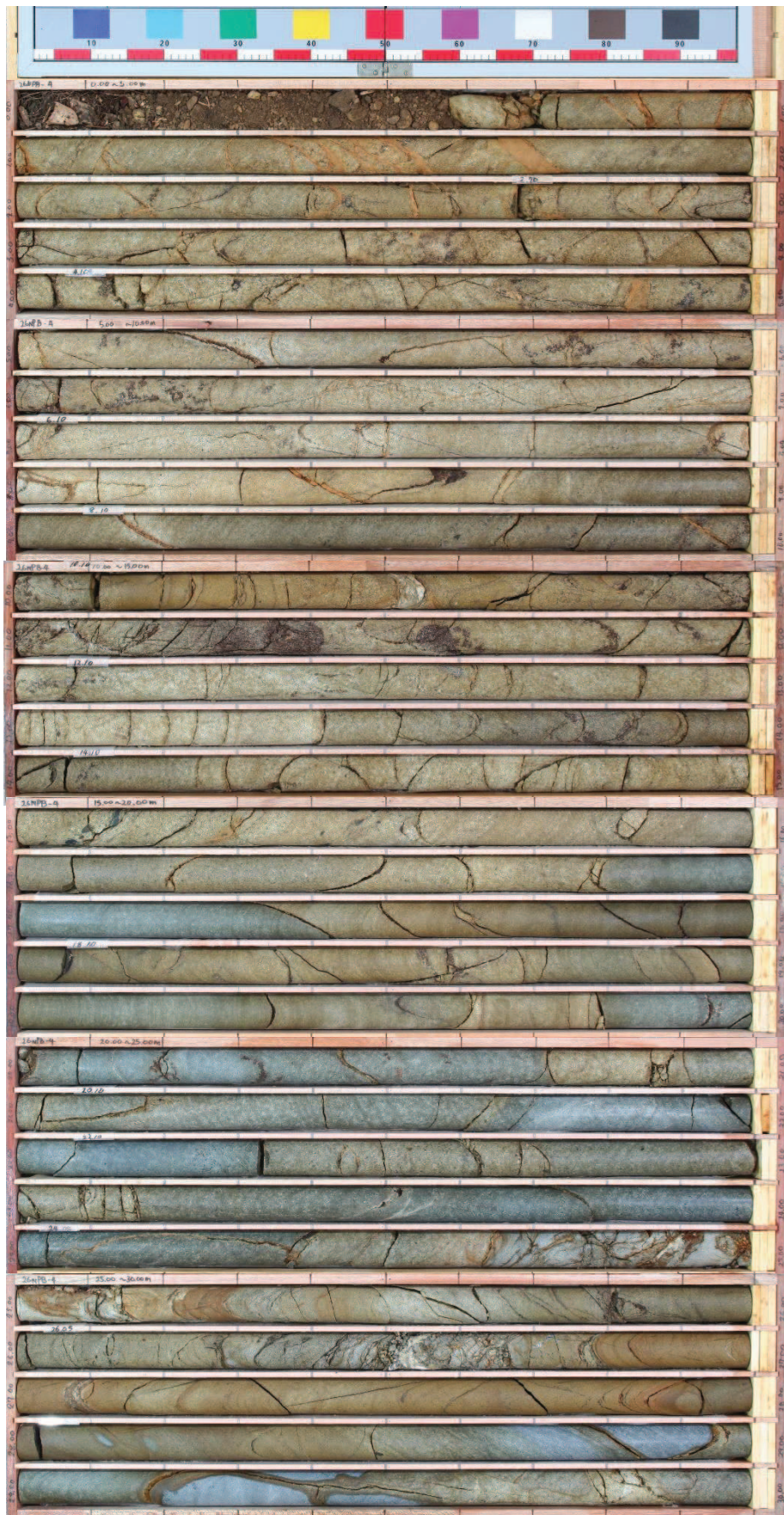
図 2-18(2) ボーリングコア写真 (26NPB-4) (深度 0~30m)
