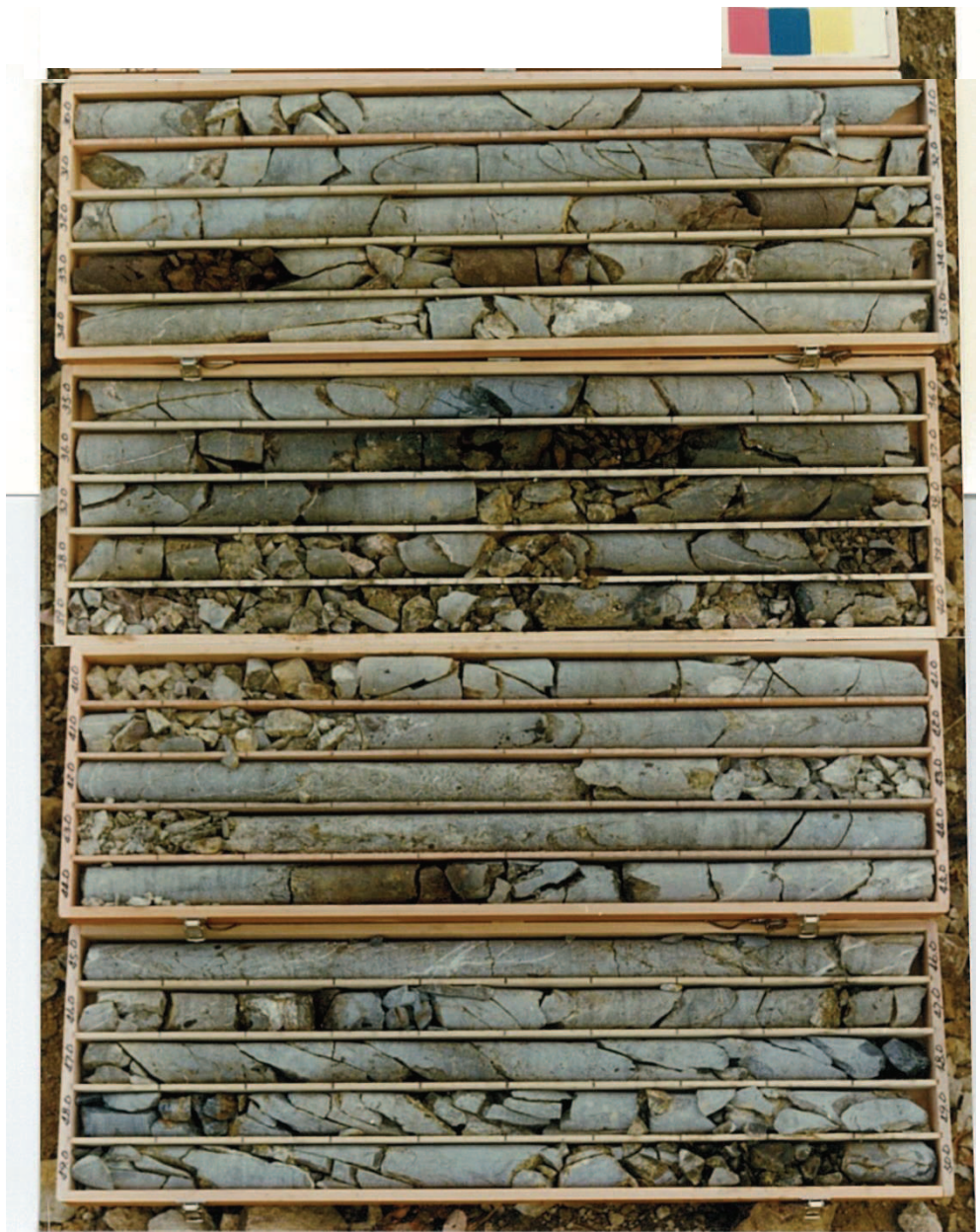
図 2-7(4) ボーリングコア写真 (B-3) (深度 30~50m)
