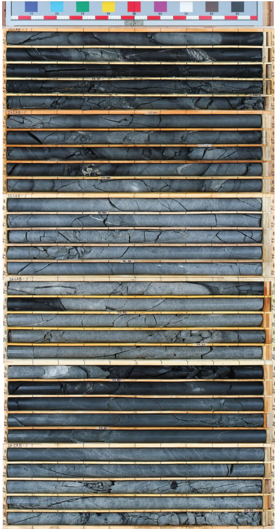
図 2-12(6) ボーリングコア写真 (26SAB-1) (深度 60~90m)
