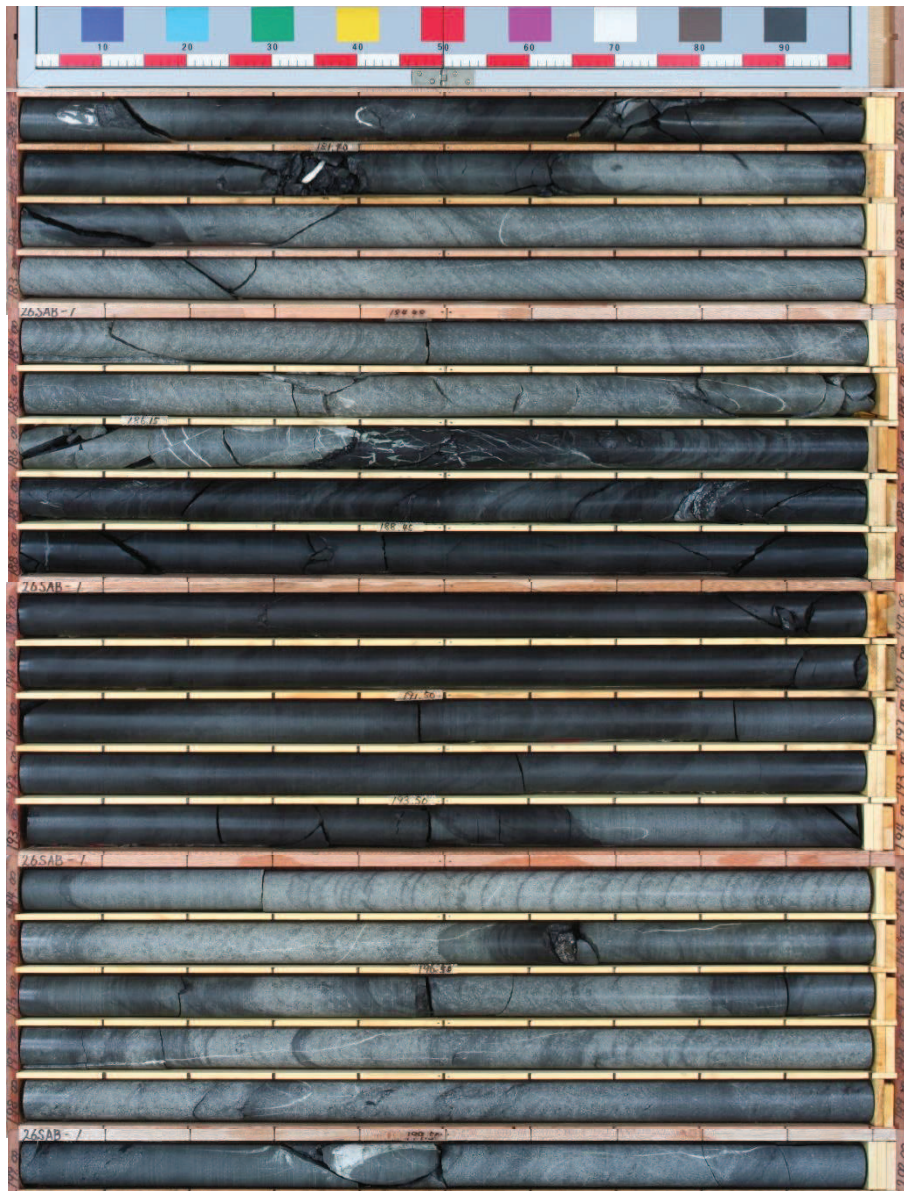
図 2-12(14) ボーリングコア写真 (26SAB-1) (深度 180~200m)
