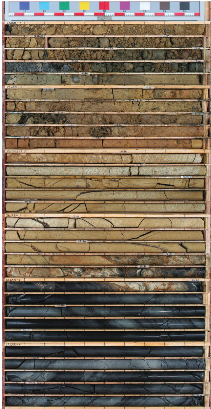
図 2-12(2) ボーリングコア写真 (26SAB-1) (深度 0~30m)
