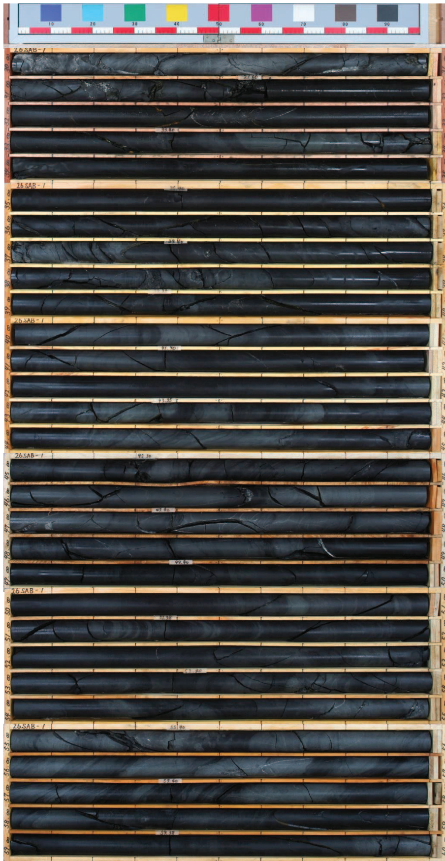
図 2-12(4) ボーリングコア写真 (26SAB-1) (深度 30~60m)
