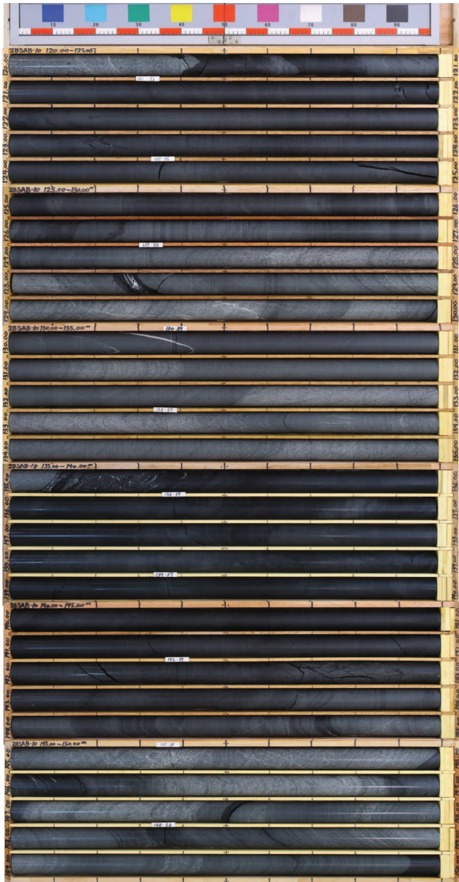
図 2-15(10) ボーリングコア写真 (28SAB-10) (深度 120~150m)
