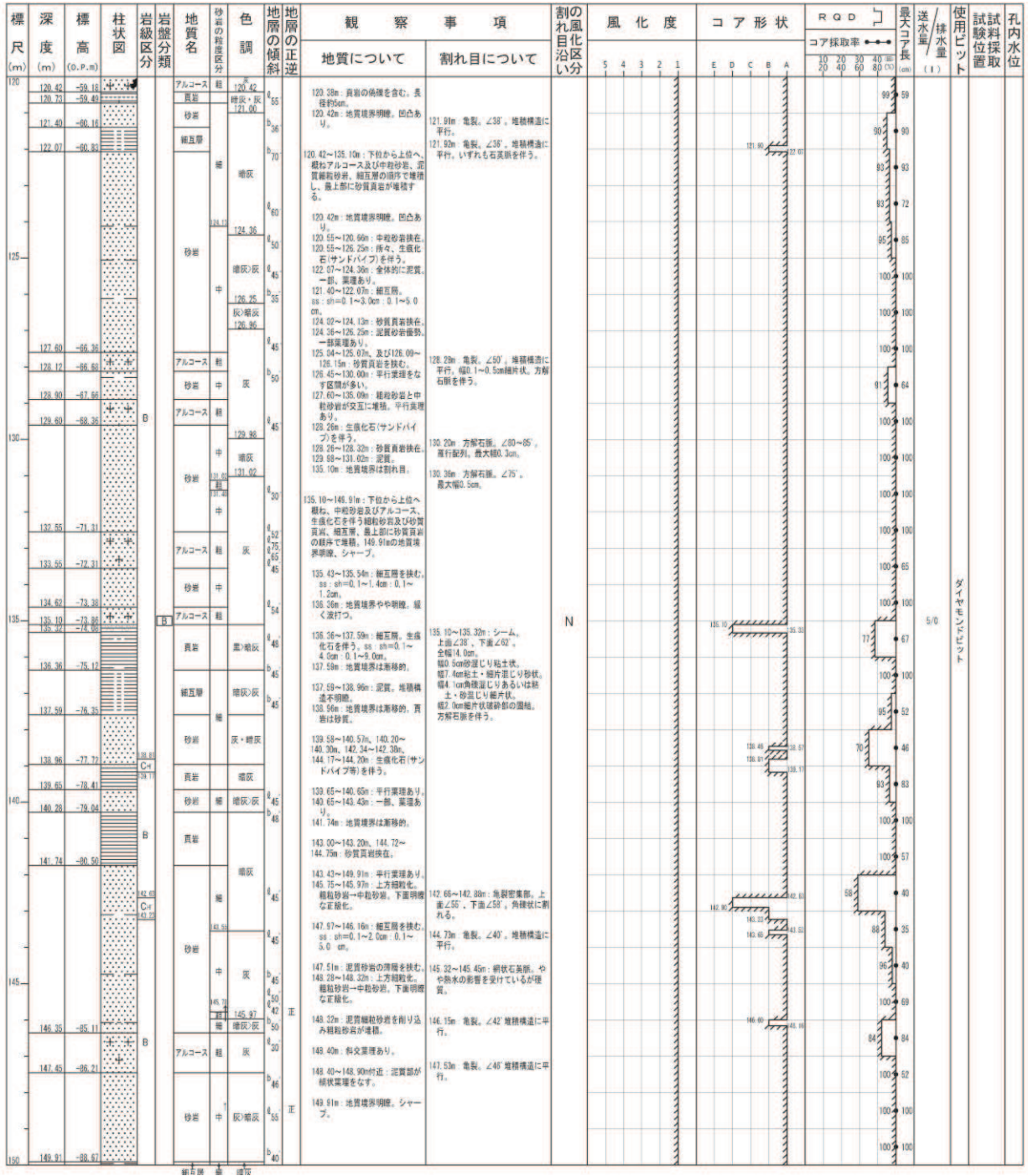
図 2-15 (9) ボーリング柱状図 (28SAB-10) (深度 120~150m)
