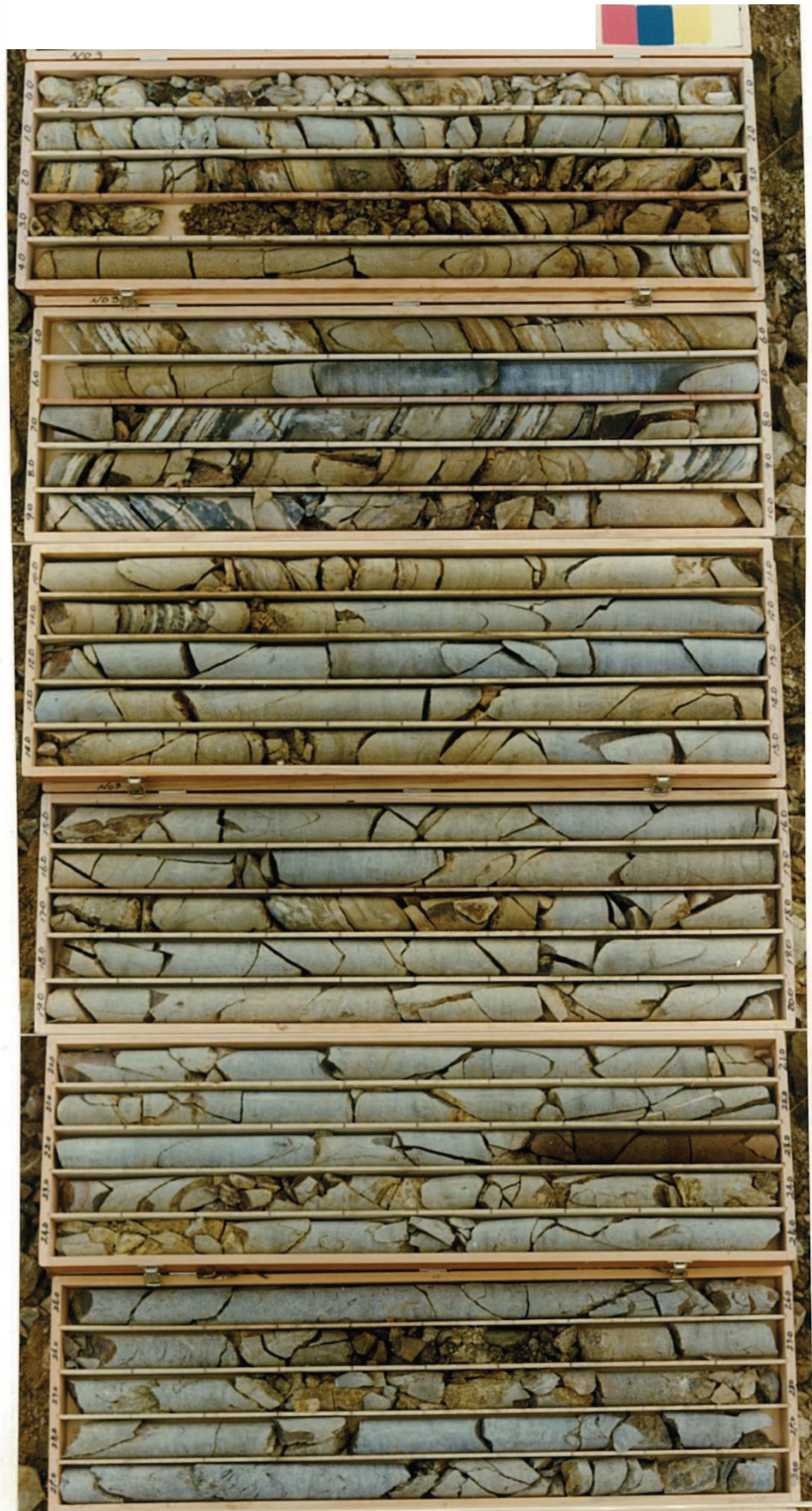
図 2-7(2) ボーリングコア写真 (B-3) (深度 0~30m)
