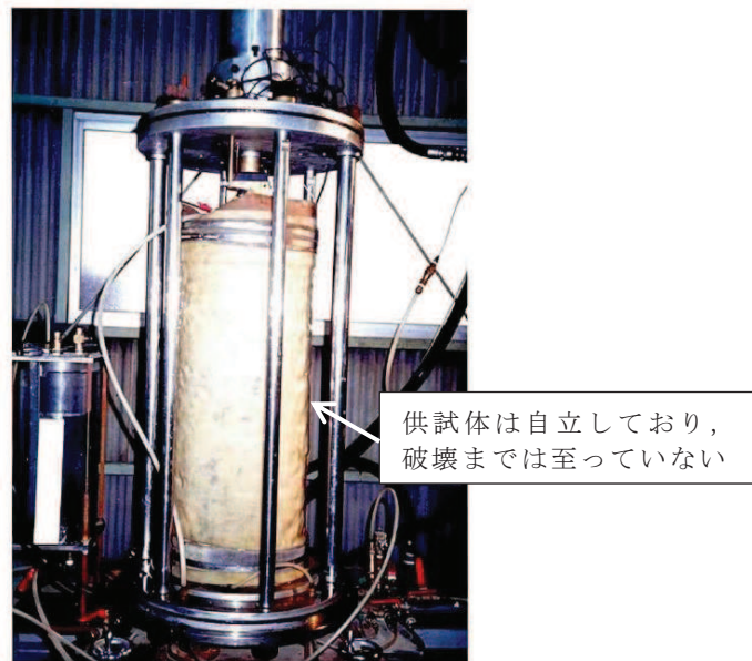
図 3-3 動的変形試験終了後の供試体
