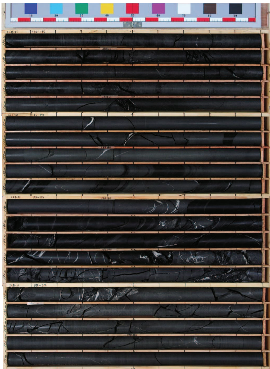
図 2-4(14) ボーリングコア写真 (24B-21) (深度 180~200m)
