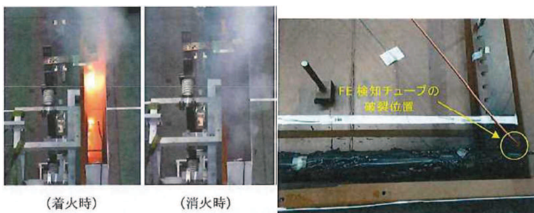
図 9 試験 V1 における発火・消火時の状態
