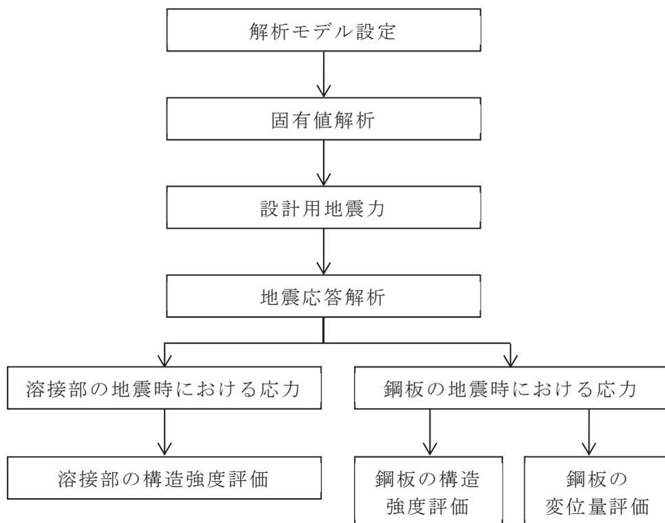
図 1-1 鋼板の耐震評価フロー
