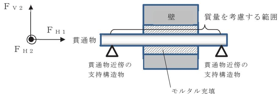
図 4-1 モルタルへの荷重作用図
