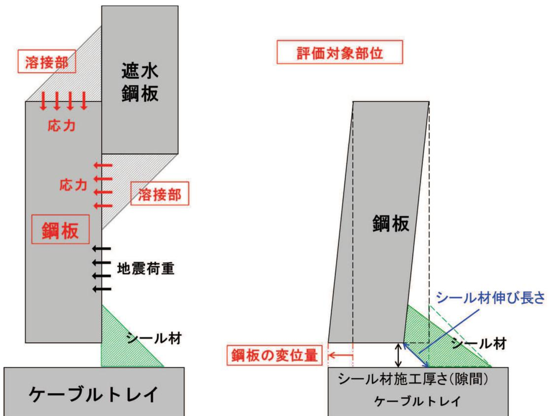
図 2-1 鋼板の評価対象部位
