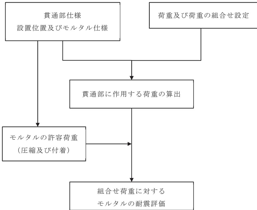
図 2-1 モルタルの耐震評価フロー
