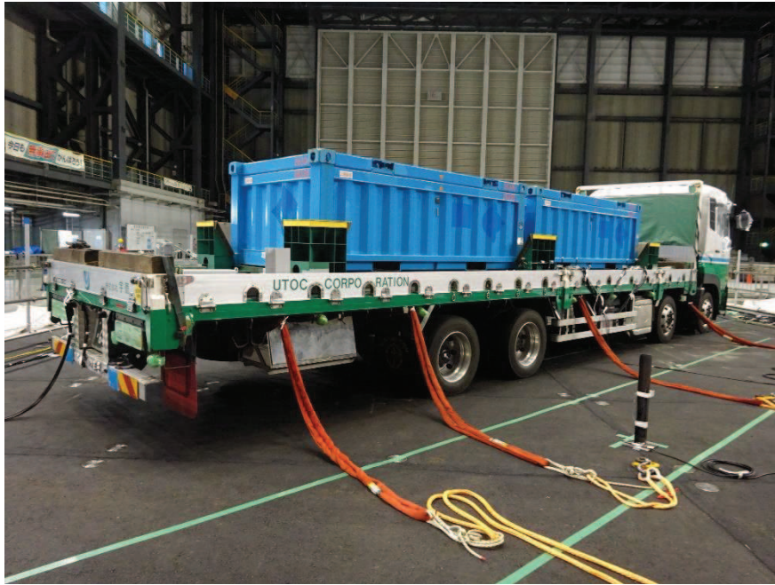
図9 加振試験時のLLW輸送車両
