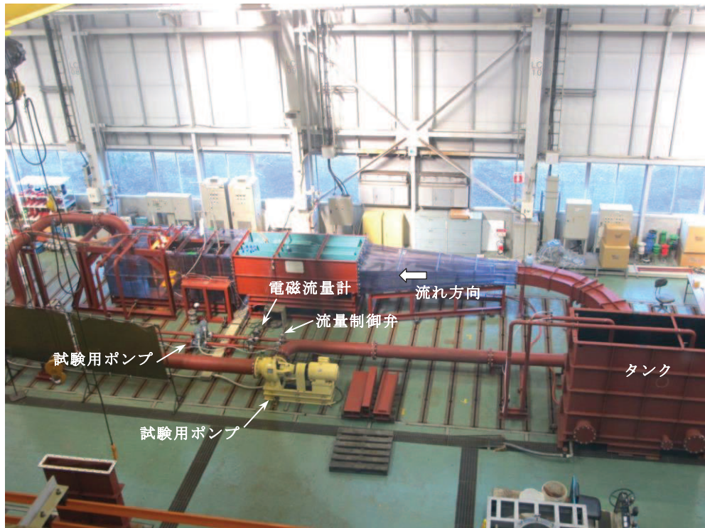
図 3-2(1) 試験装置全景
