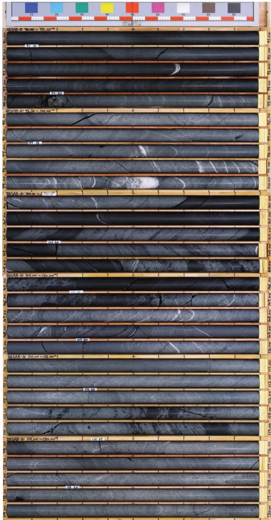
図 2-15(8) ボーリングコア写真 (28SAB-10) (深度 90~120m)
