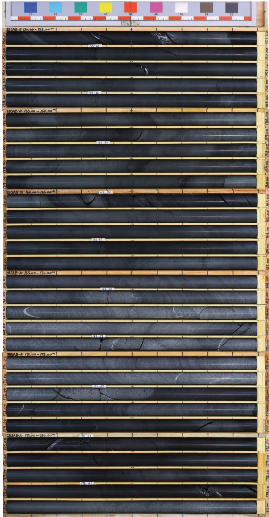
図 2-15(12) ボーリングコア写真 (28SAB-10) (深度 150~180m)
