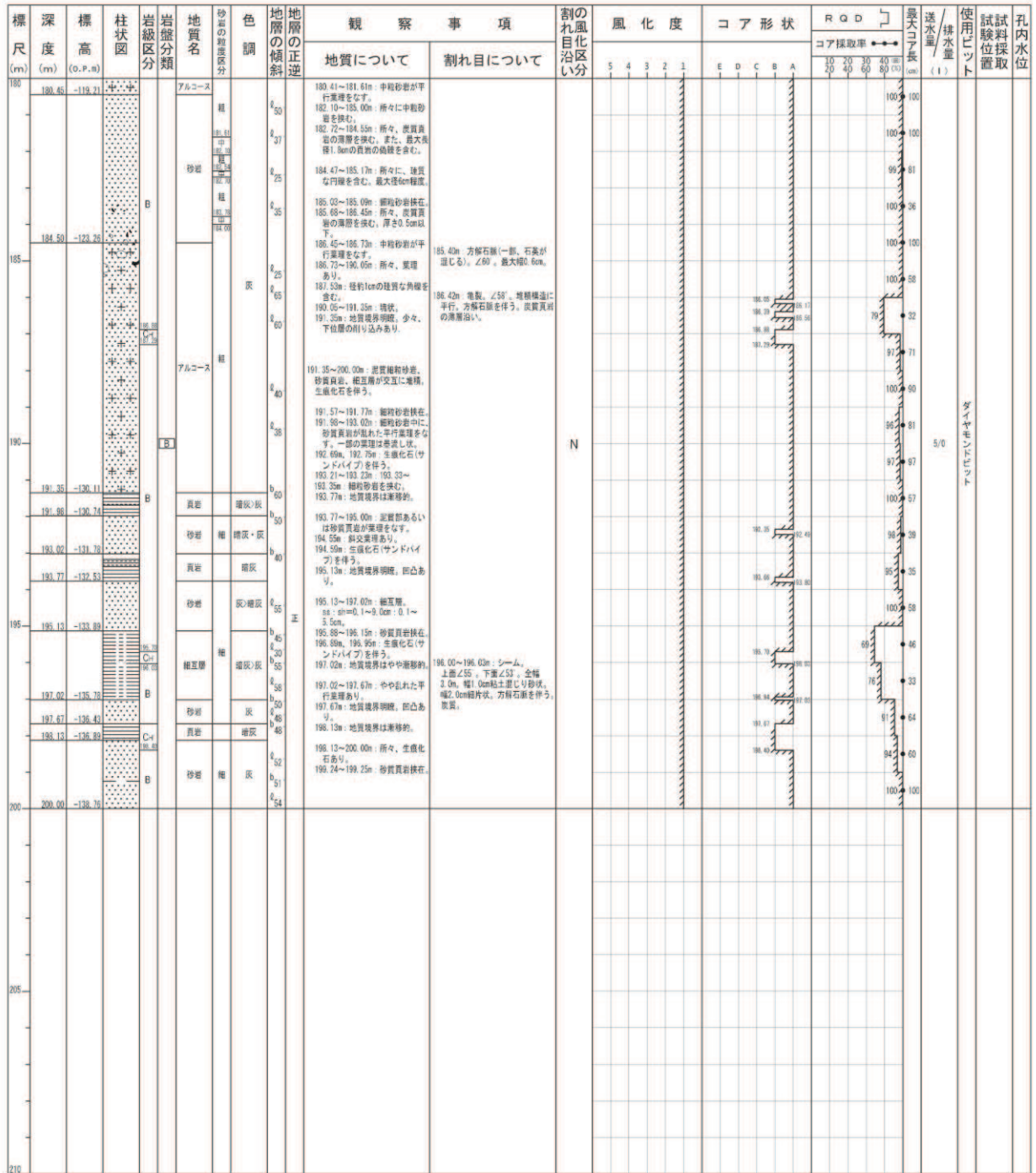
図 2-15(13) ボーリング柱状図 (28SAB-10) (深度 180~200m)
