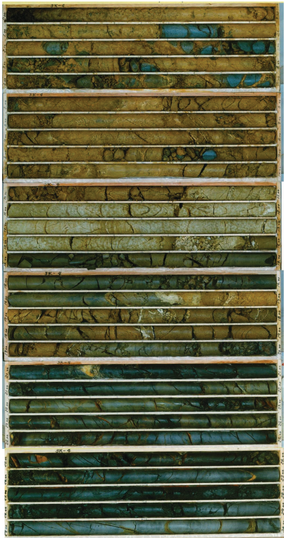
図 2-11(2) ボーリングコア写真 (3k-4) (深度 0~30m)
