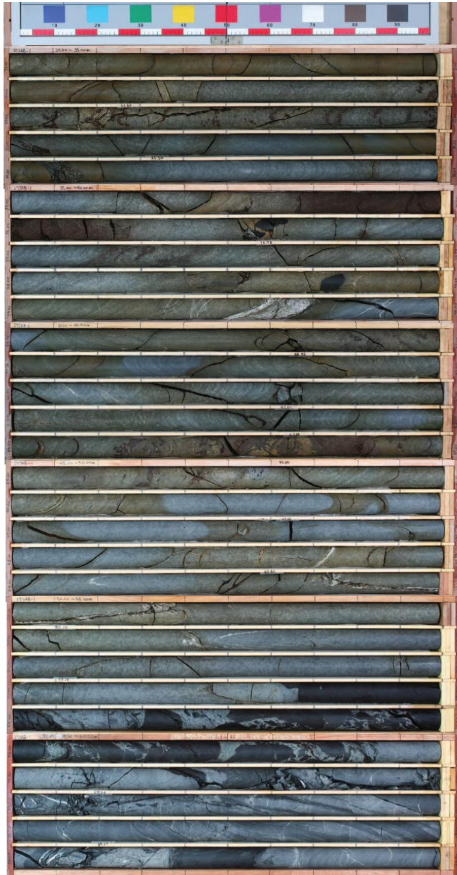
図 2-16(4) ボーリングコア写真 (27SAB-1) (深度 30~60m)
