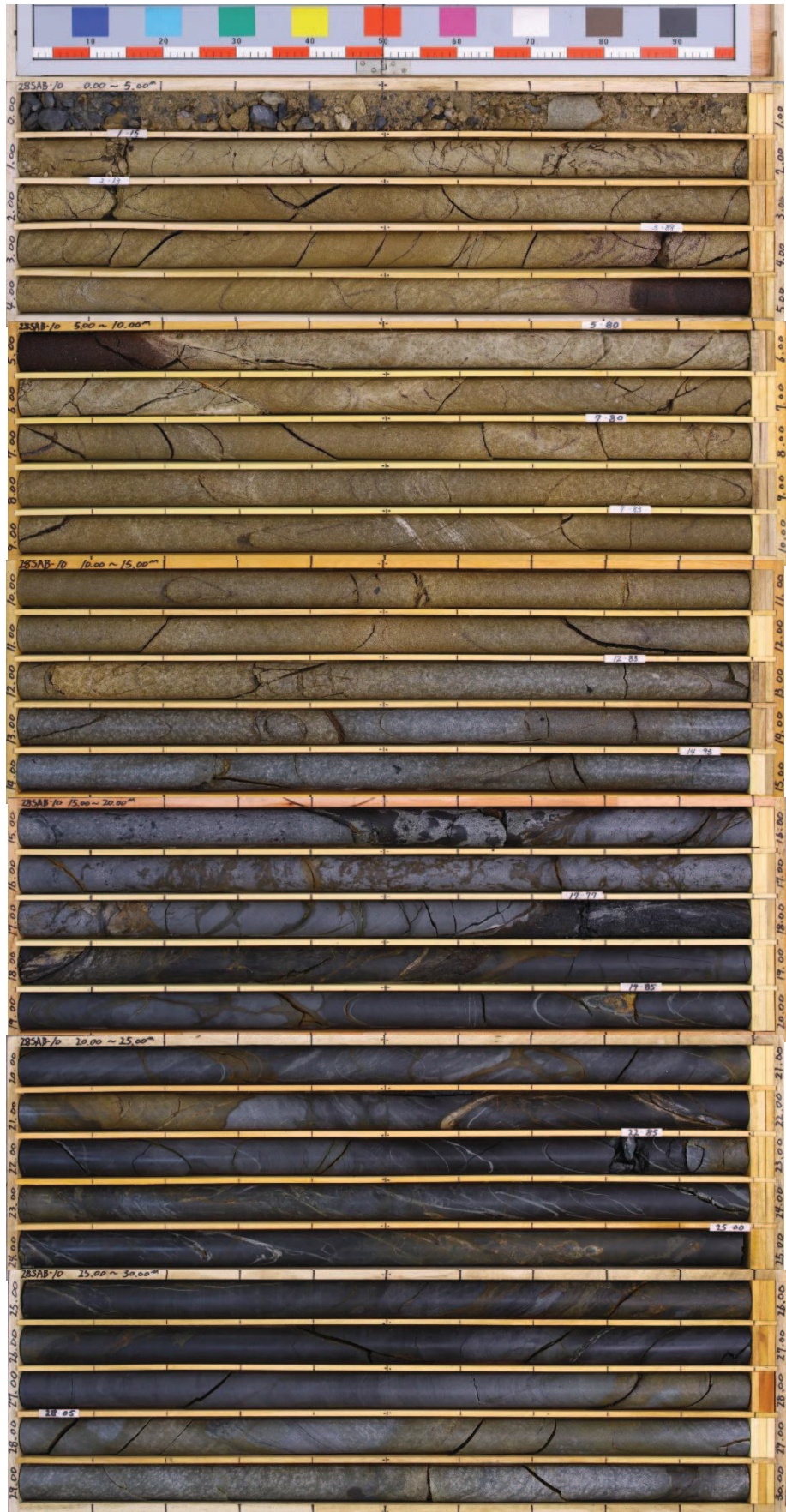
図 2-15(2) ボーリングコア写真 (28SAB-10) (深度 0~30m)
