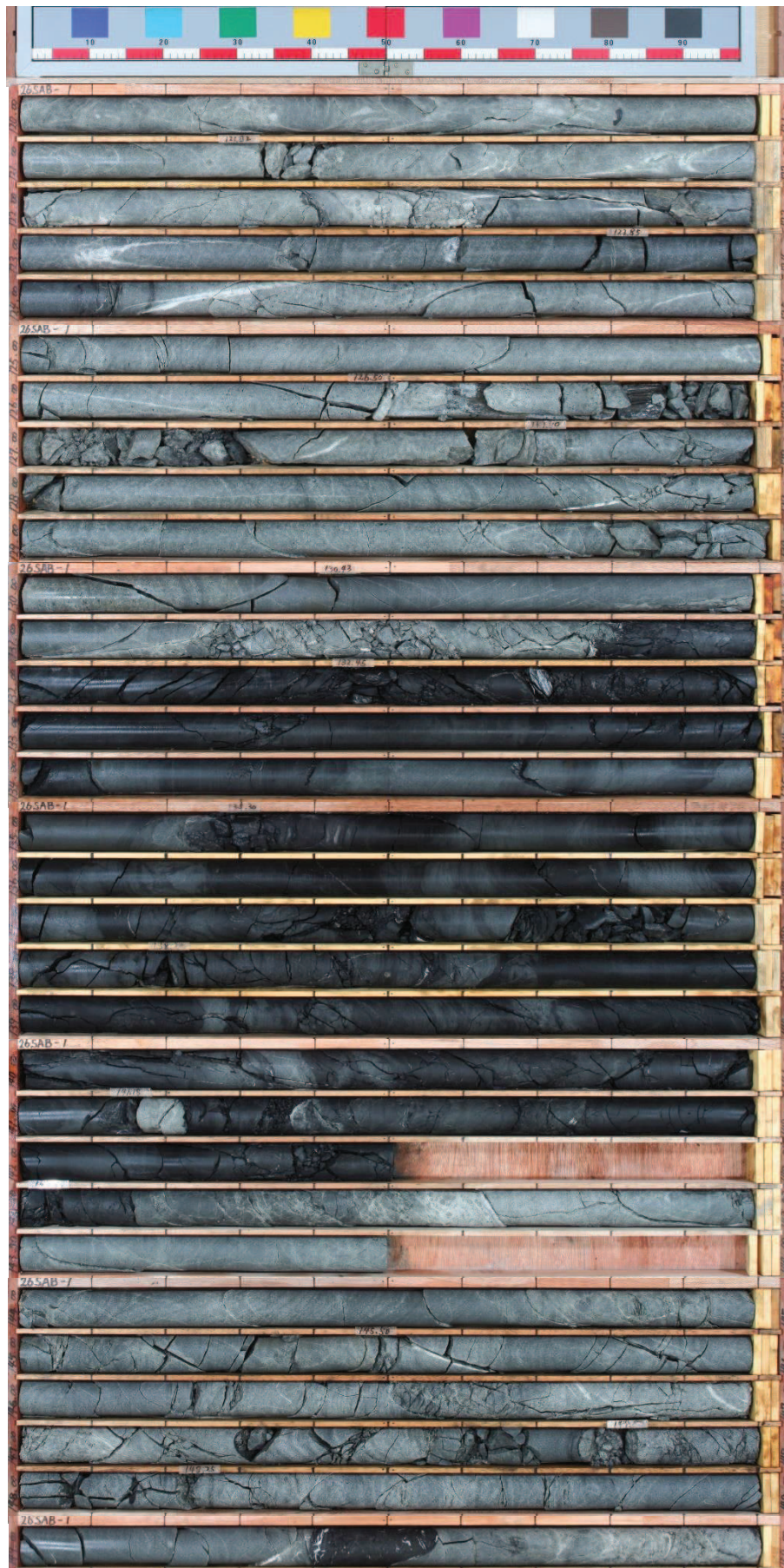
図 2-12(10) ボーリングコア写真 (26SAB-1) (深度 120～150m)
