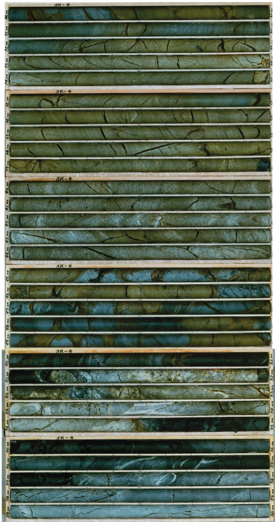
図 2-11(4) ボーリングコア写真 (3k-4) (深度 30~60m)
