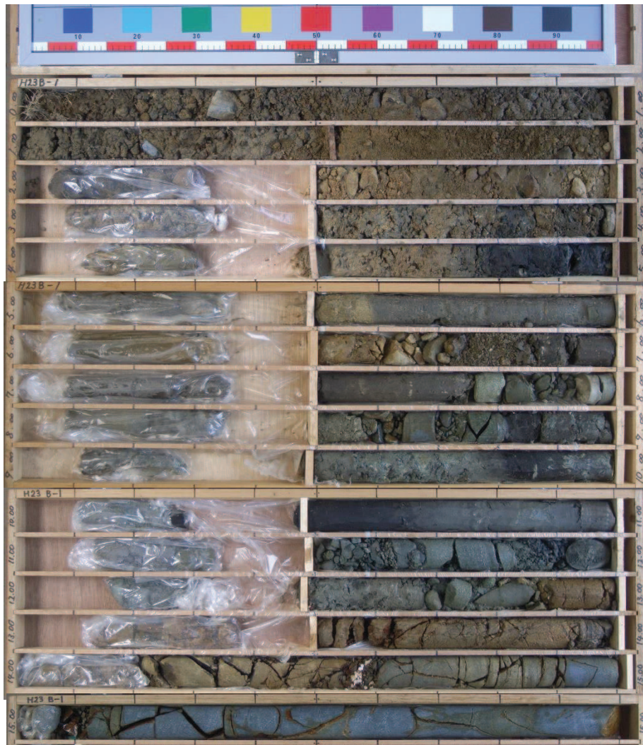
図 2-13(2) ボーリングコア写真 (H23B-1) (深度 0~16m)
