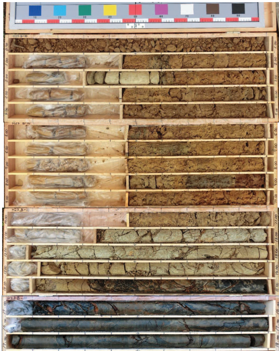
図 2-6(2) ボーリングコア写真 (H23B-10) (深度 0~18m)
