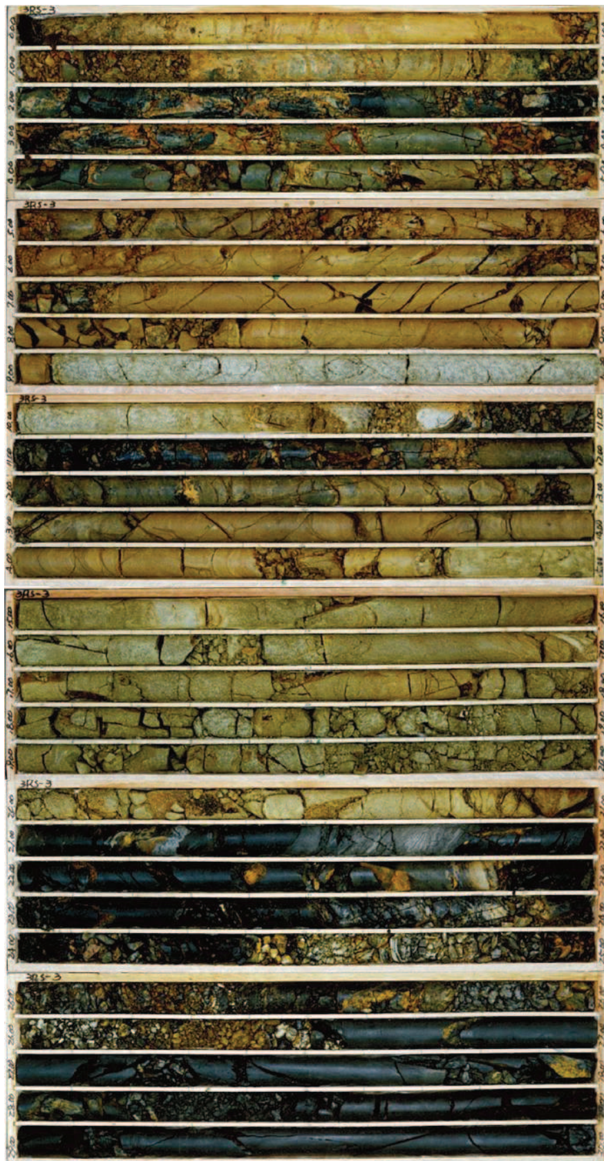
図 2-8(2) ボーリングコア写真 (3Rs-3) (深度 0~30m) (第 417 回審査会合 机上配布資料 女川原子力発電所 2 号機 敷地の地形、地質・地質構造につ いて (コメント回答) 資料集 (ボーリング柱状図・コア写真) p. 193 再掲)
