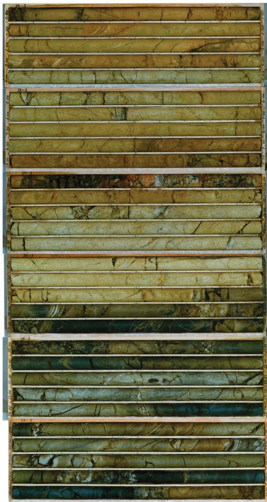
図 2-10(2) ボーリングコア写真 (3k-3) (深度 0~30m)
