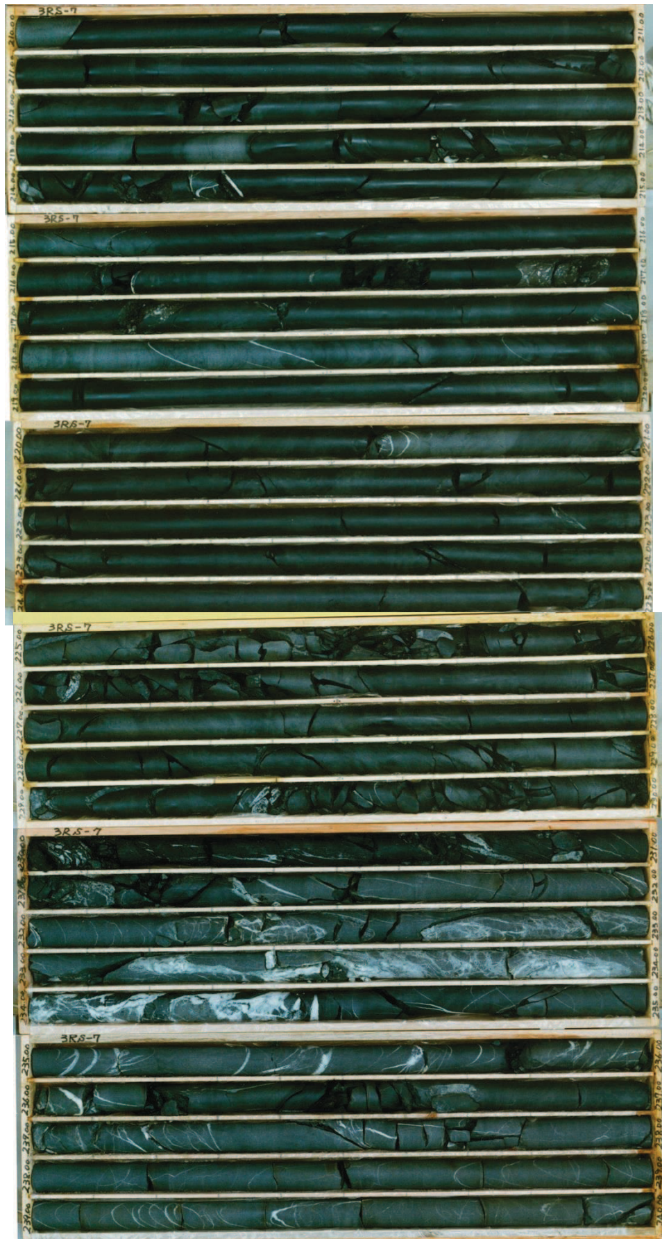
図 2-5(16) ボーリングコア写真 (3Rs-7) (深度 210~240m)
