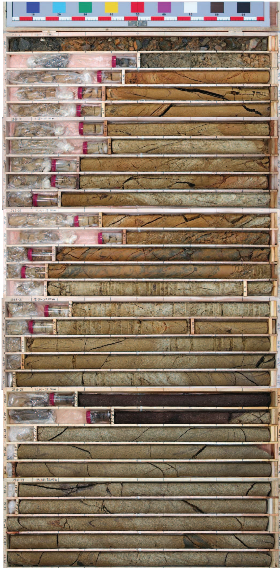
図 2-4(2) ボーリングコア写真 (24B-21) (深度 0~30m)
