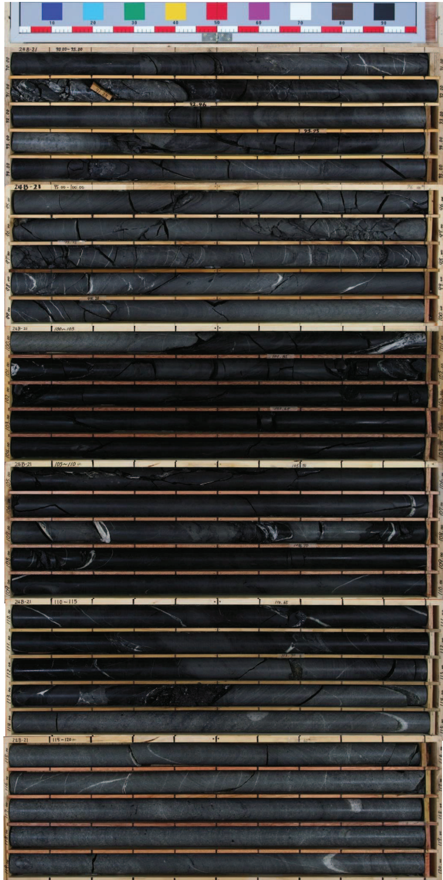
図 2-4(8) ボーリングコア写真 (24B-21) (深度 90~120m)
