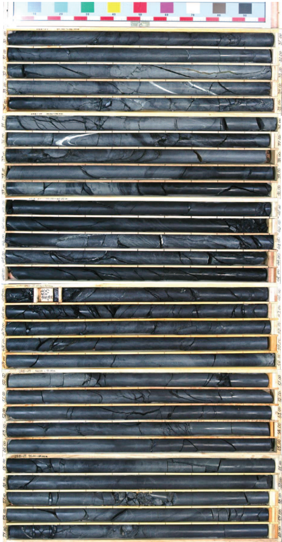
図 2-3(4) ボーリングコア写真 (24B-27) (深度 30~60m)
