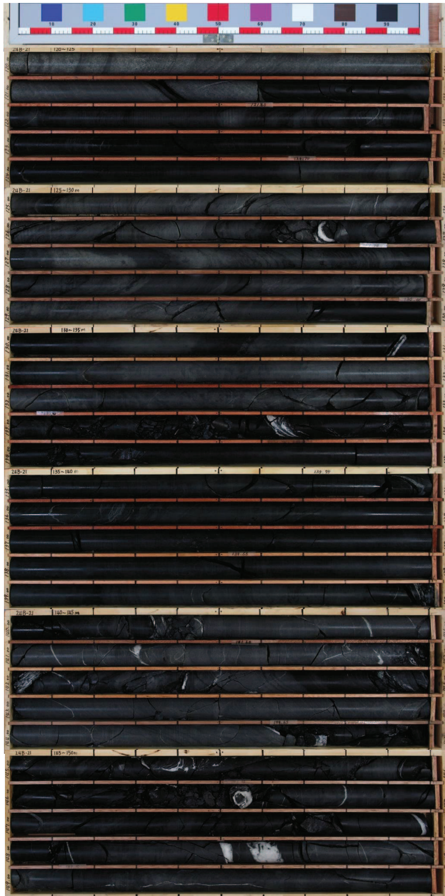
図 2-4(10) ボーリングコア写真 (24B-21) (深度 120~150m)
