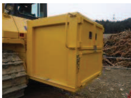
図 2 角材及び土のうの積載箇所 (ブルドーザ)
