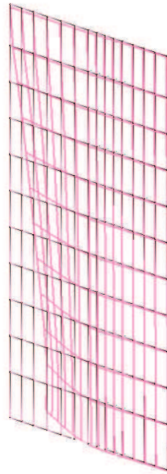
图 7.2-8(3) 变形图 (重叠时 0.4Sd 水平_-1.0Sd 铅直)
