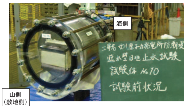
加圧前状況（敷地側）
