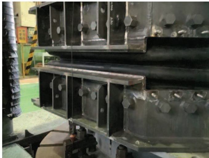
図 6.1.5-12(2) ゴムジョイント設置状況
