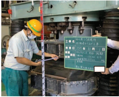
せん断方向距離計測状況
