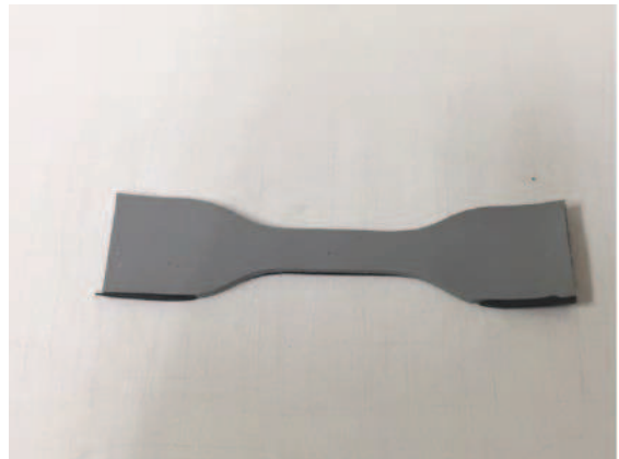
シリコン材をを2号ダンベルに打ち抜く
