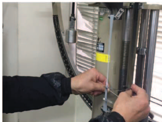
図 6.1.5-35(4) シリコン材の耐候性試験（引張試験）
