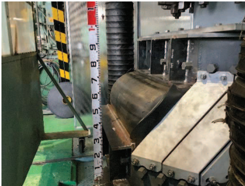
加圧状況 (漏えい無し)
