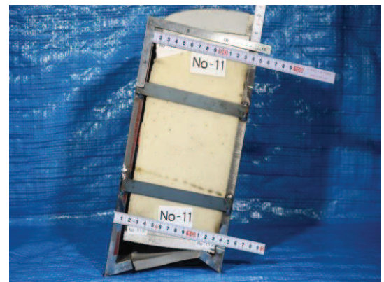
図3 ウレタンシリコーン目地変形試験状況
