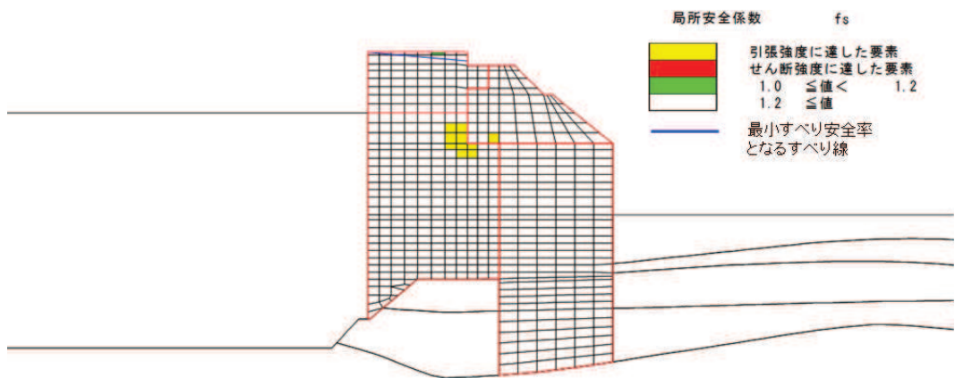
図 4.2-3(3) 背面補強工の最小すべり安全率時刻における局所安全係数分布 (断面③, S d - D 2 (-+), t=13.58s )
