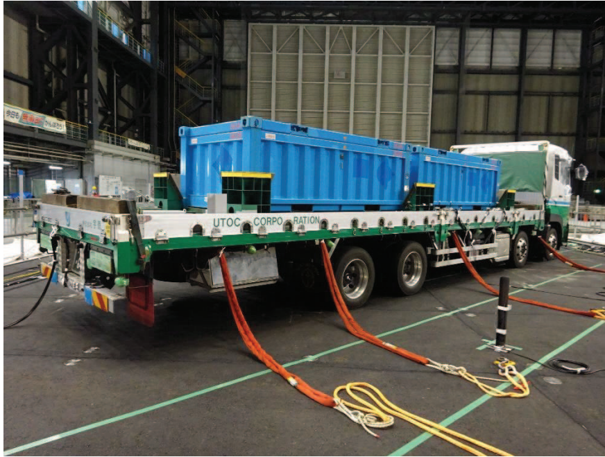
図9 加振試験時のLLW輸送車両
