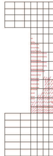
308STEP 斜めひび割れ進行
