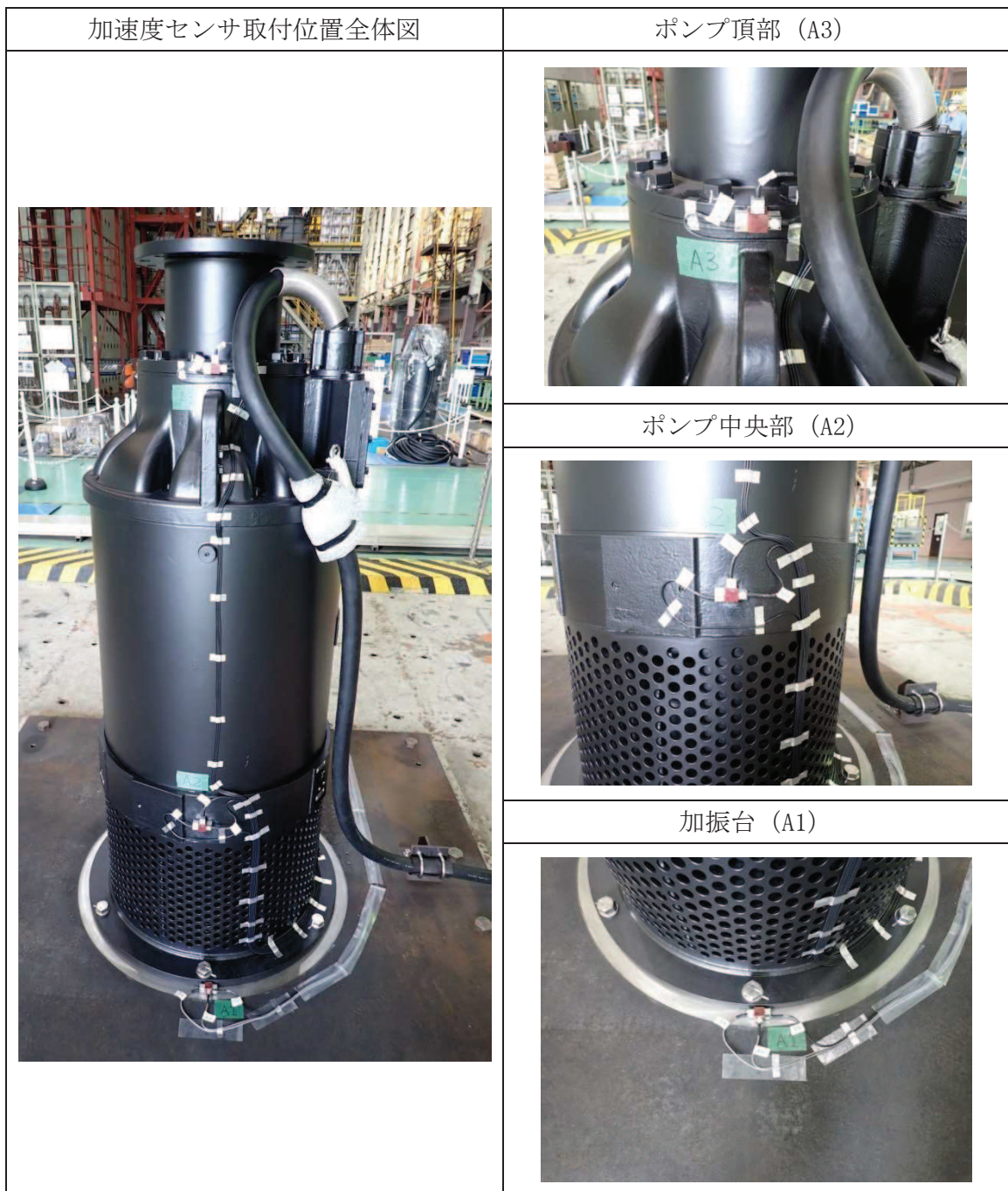
図 2-1(a) 加速度センサ取付位置 (水平 X 方向+鉛直方向加振試験)
