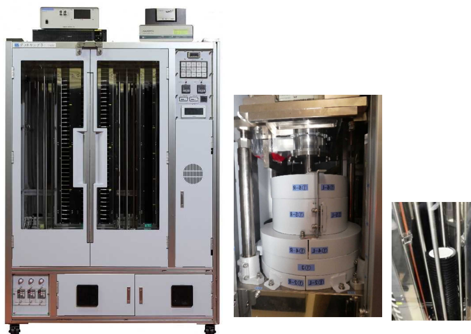
図参 C-6 ゲルマニウム半導体検出器を用いたダストモニタの例
