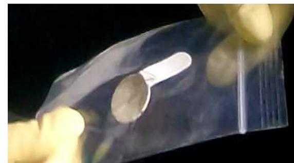
採取したスミア試料の例
