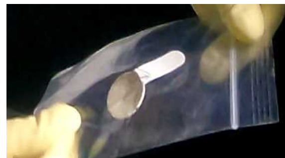
採取したスミア試料の例
