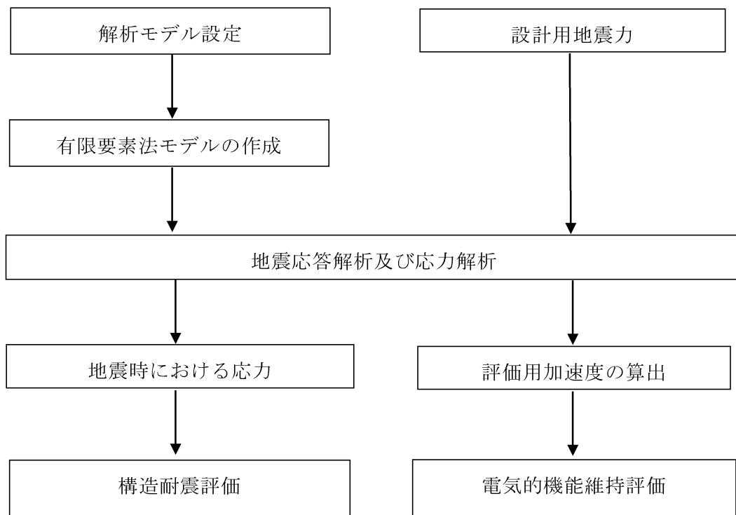
第2-1図 充電器（3系統目蓄電池用）の耐震評価フロー
