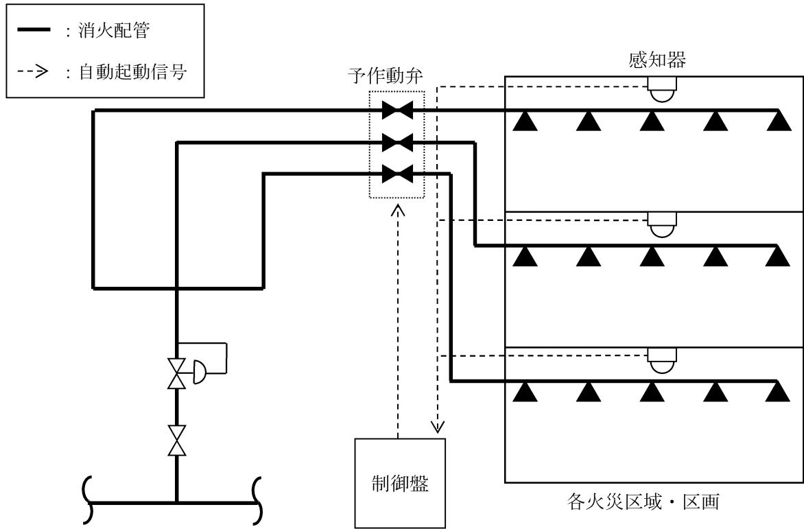
第5-7図 スプリンクラー 自動起動信号
