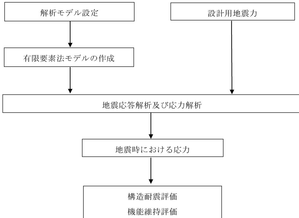
第2-1図 蓄電池（3系統目）の耐震評価フロー
