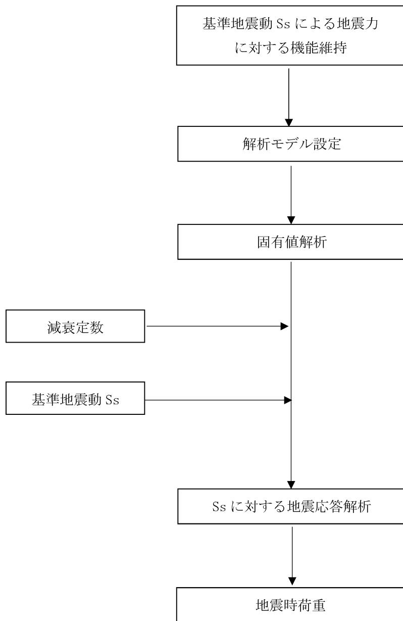
第4-1図 消火設備の地震応答解析フロー
