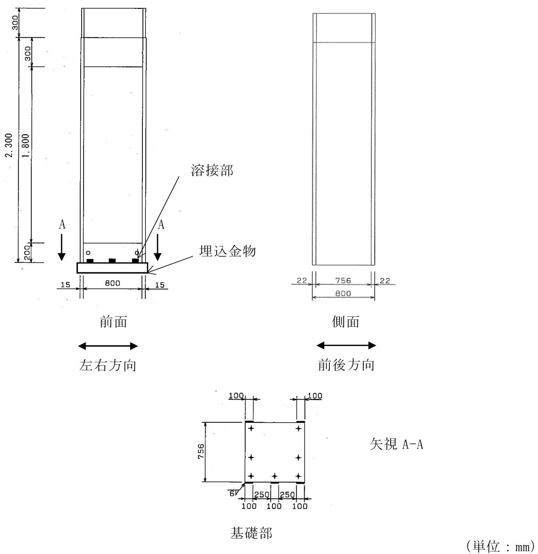
第2-1図 切替盤（3系統目蓄電池用）の外形図
