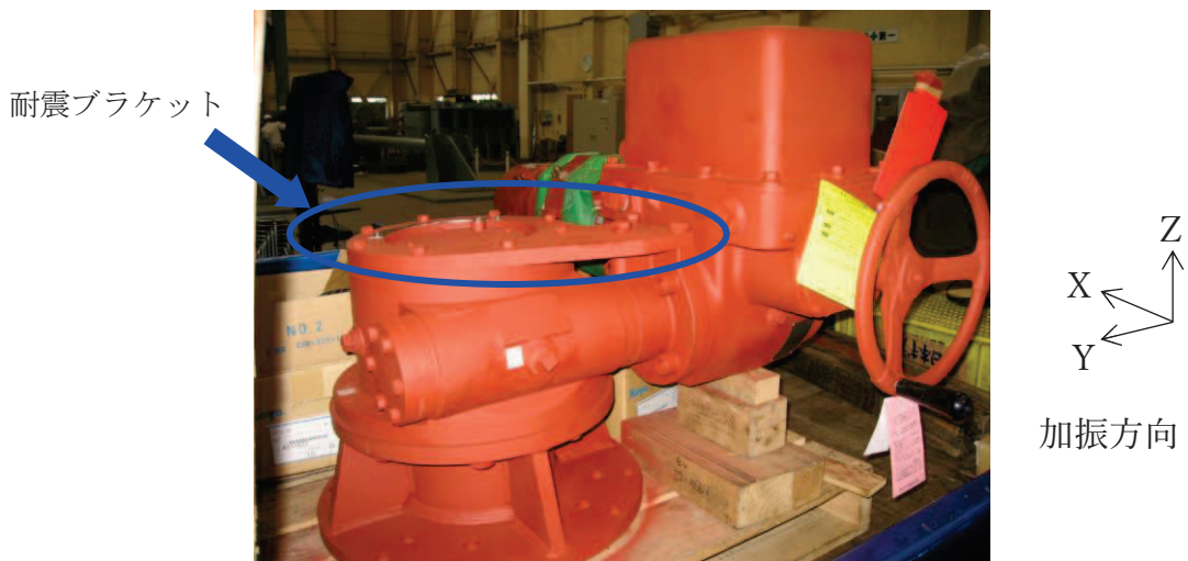
図 2.4-8 二次減速機付き電動弁駆動部（補強後）
