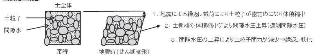
図 3.4-15 液状化の概念図
