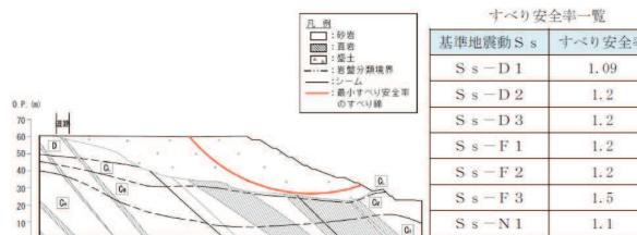
図2.3.2-8 斜面Bのすべり安定性評価結果
