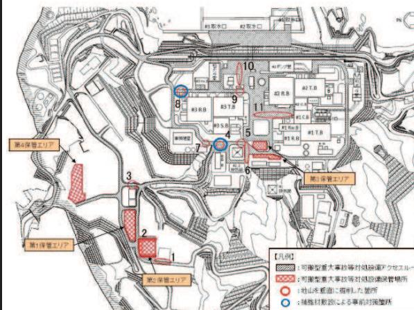
図3.3.3-9 拡張材敷設による事前の段差緩和対策を実施する箇所
