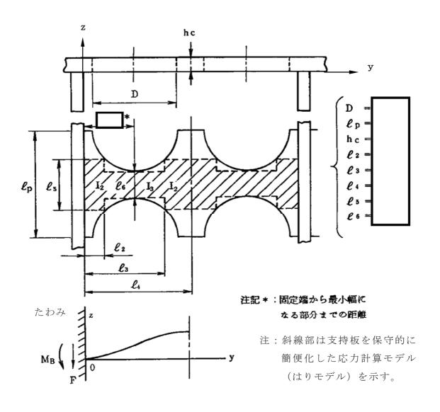
図3-2(1) 支持板の応力計算モデル
