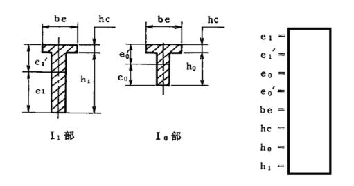
図 3-1(2) 補強ビームの応力計算モデル
