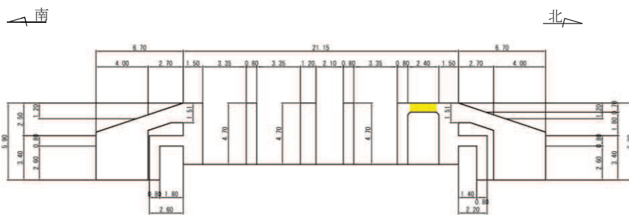
図 2-11 Ccbによる耐震補強箇所 (断面②)
